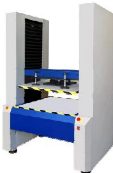
**Figura 51. Equipo para realizar Ensayos de Aplastamiento Plano en muestras pequeñas de cartón**
