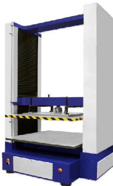
**Figura 52. Equipo para realizar Ensayos de Aplastamiento Vertical del Cartón**
