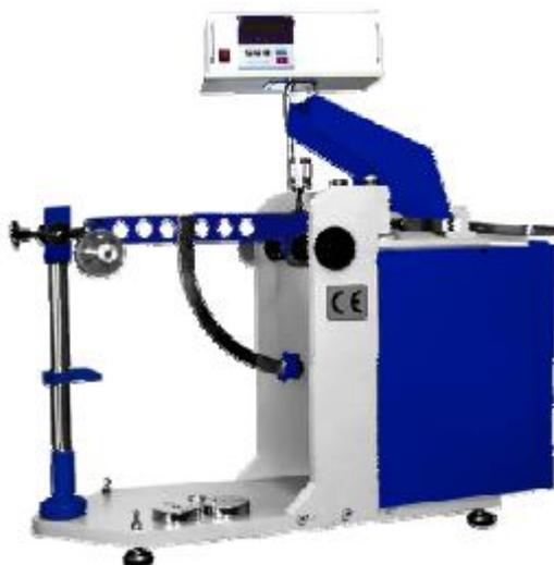
**Figura 50. Equipo para realizar Ensayos de Penetración o Perforación de Cartón**
