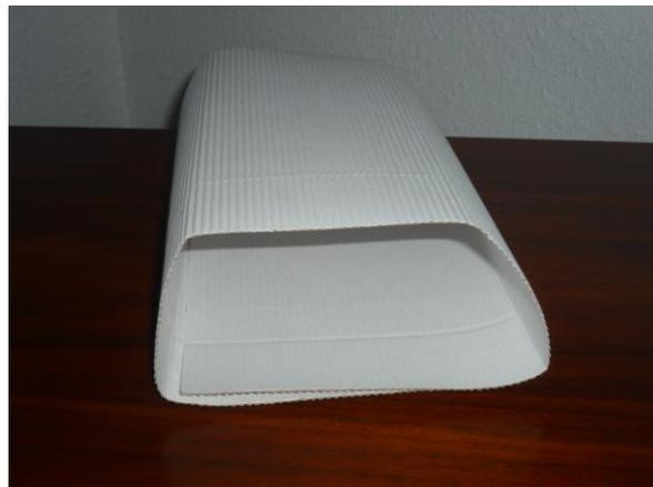
**Figura 11. Láminas de cartón micro corrugado en Single Face E**
