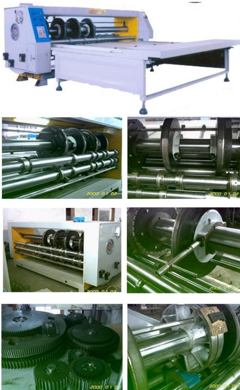
**Figura 42. Grafadora y Ranuradora Semiautomática**
