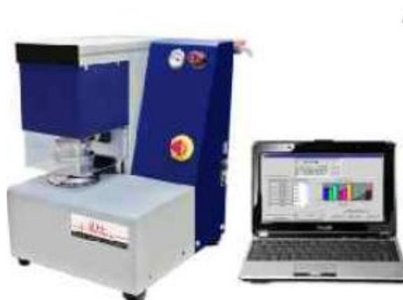
**Figura 49. Equipo para realizar Ensayos de Estallido de Papel y Cartón**
