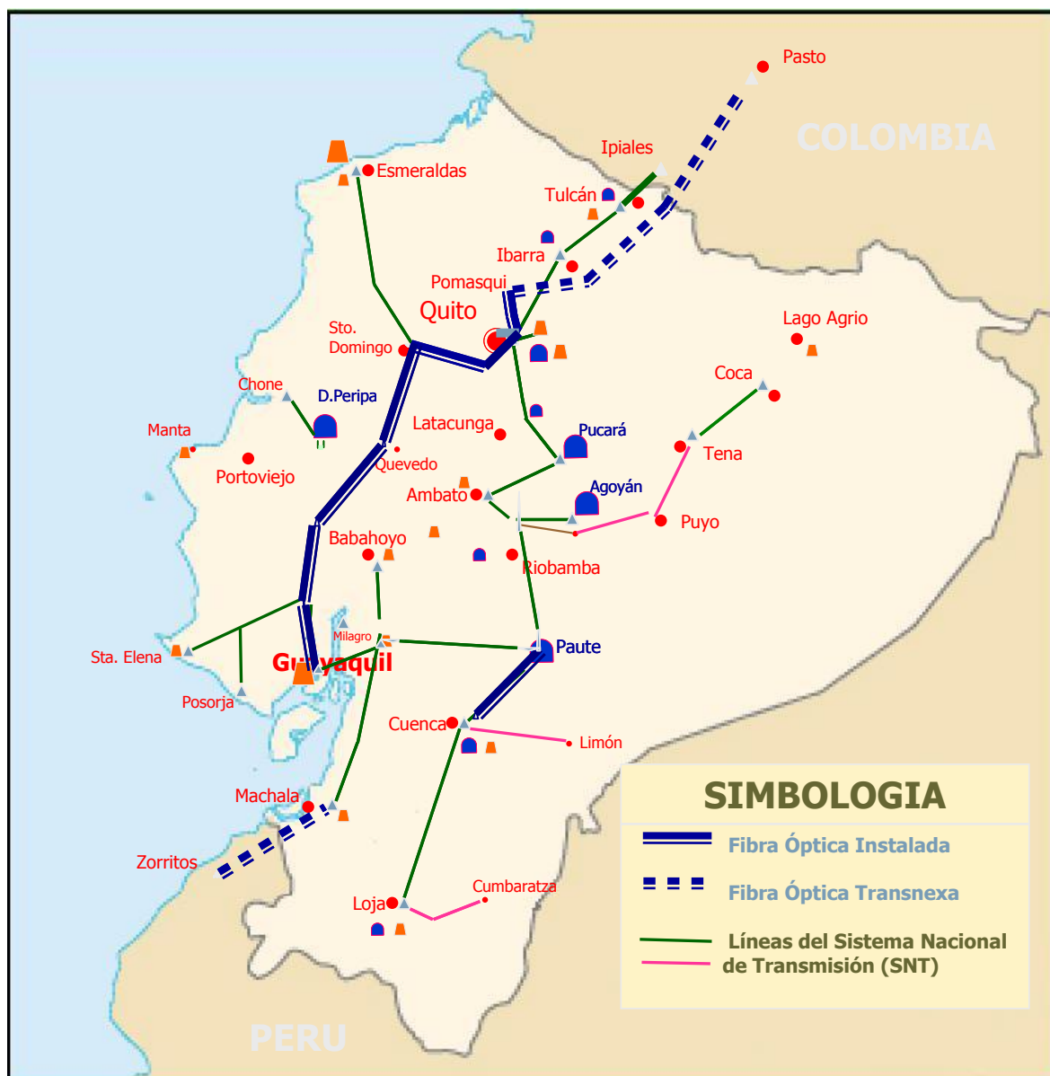
Figura 1.5.- Red de fibra óptica de TRANSELECTRIC S.A. y TRANSNEXA S.A. E.M.A. (instalada)
