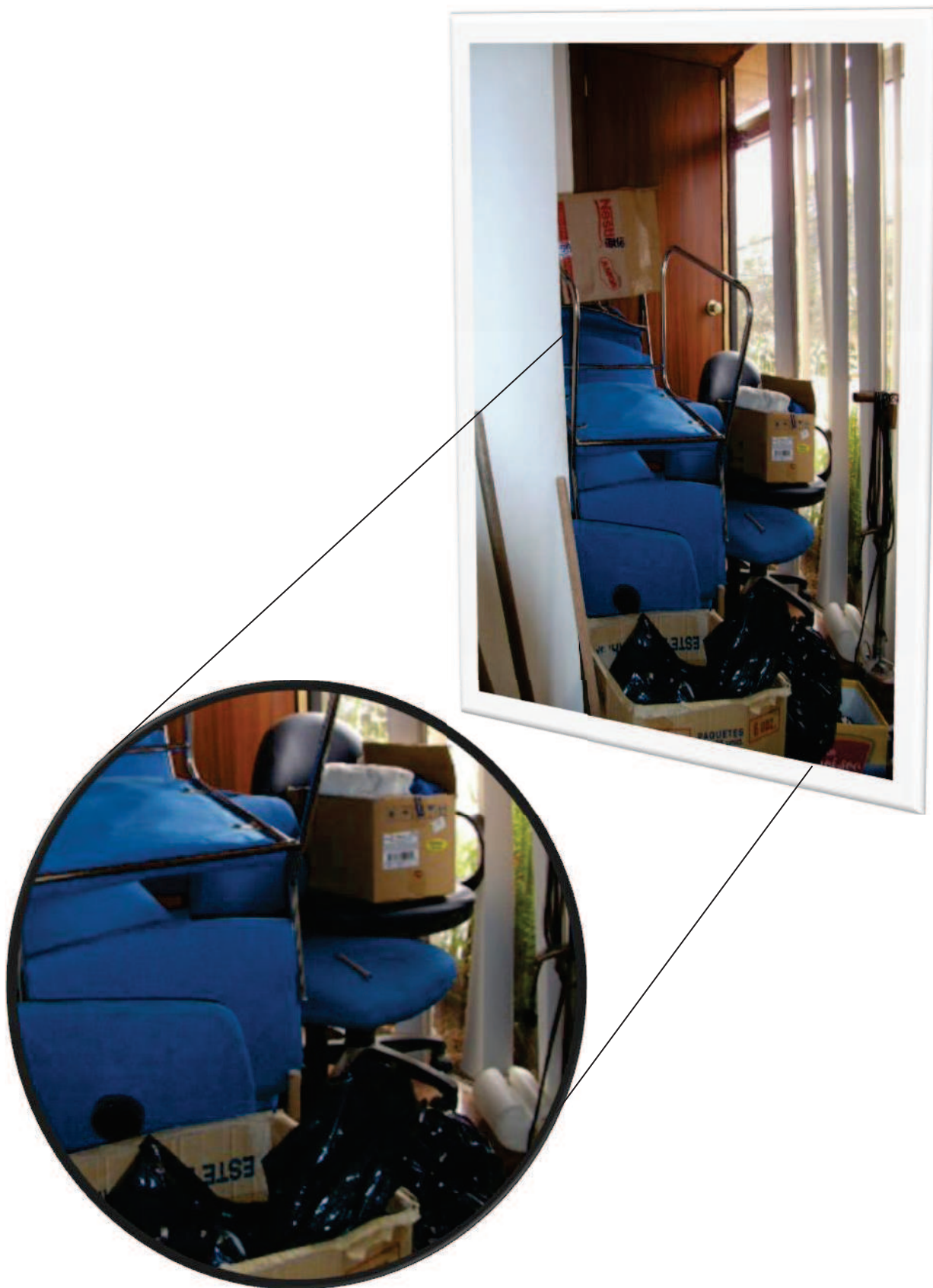
Figura A.III.13. Factores de riesgo que propician la propagación del incendio. Aglomeración de material combustible en local no sectorizado como área de almacenamiento.
