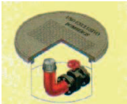
Figura 1.17. Hidrante de arqueta. (APCI, 2009)
