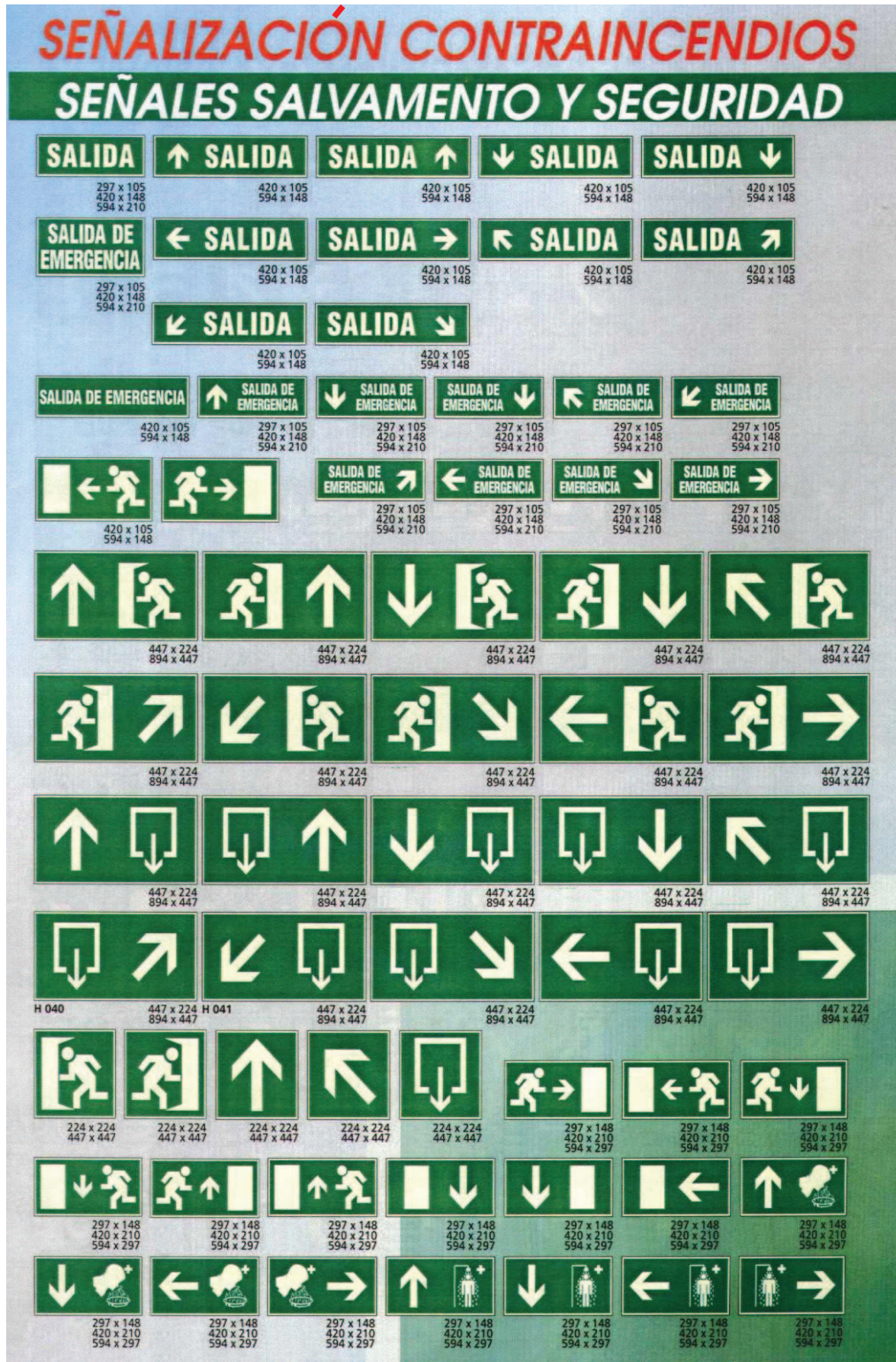
Figura A.VIII.1. Señales de salvamento y seguridad.
