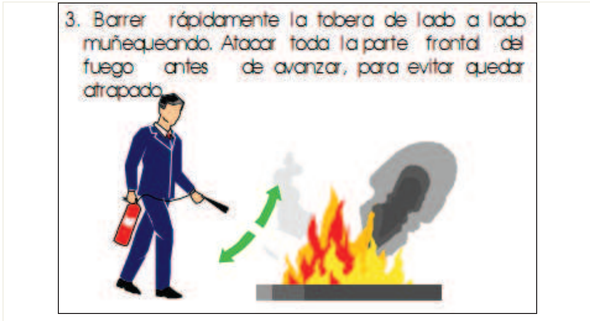
Figura A.VII.3. Técnica de barrido rápido con la tobera del extintor.
