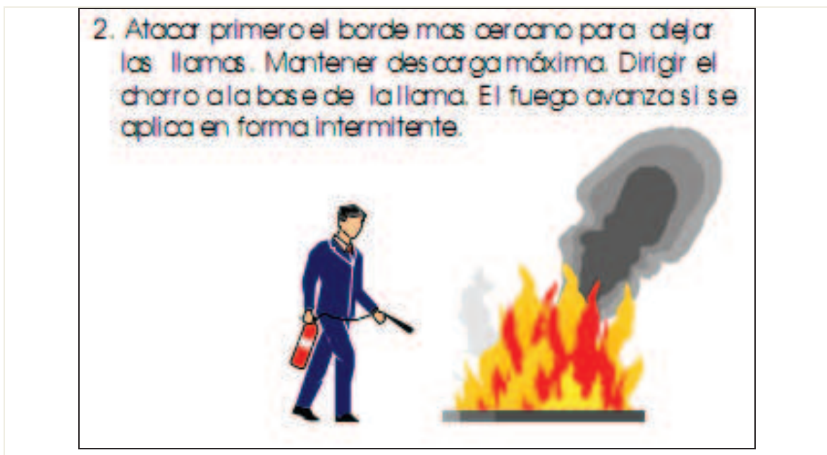
Figura A.VII.2. Técnica de ataque primario del borde más cercano.
