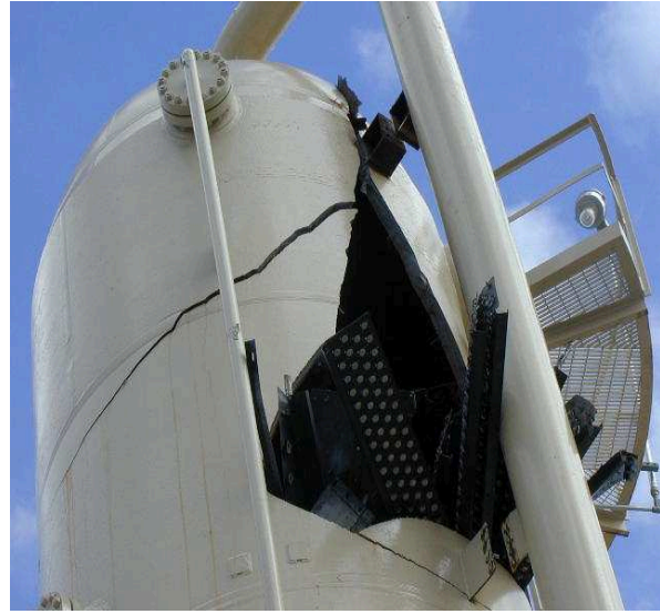
Figura 3.13 Ruptura frágil por pruebas a baja temperatura
