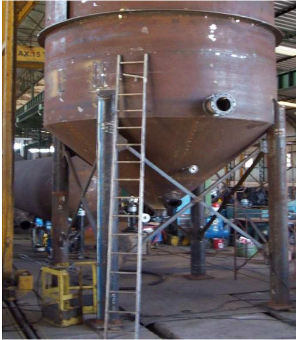
Figura 2.38 Tanque con fondo cónico
