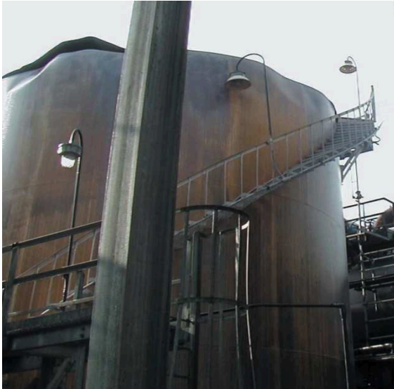
Figura 3.12 Ruptura dúctil por sobrepresión
