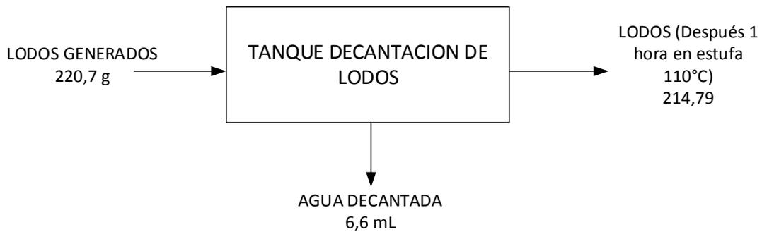
**Figura AX.2.** Balance de masa en el tanque de decantación de los lodos
