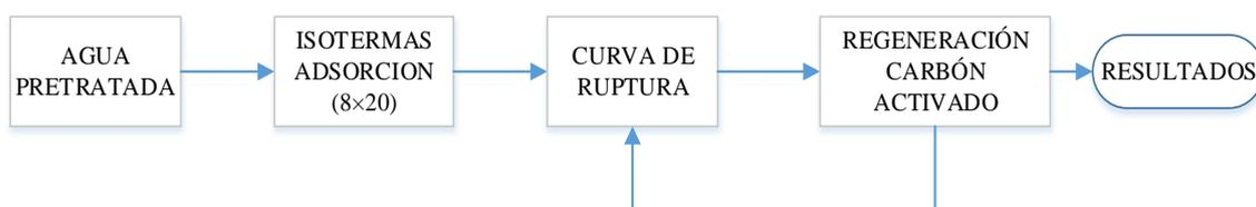
**Figura 2.2.** Metodología experimental para la adsorción en carbón activado
