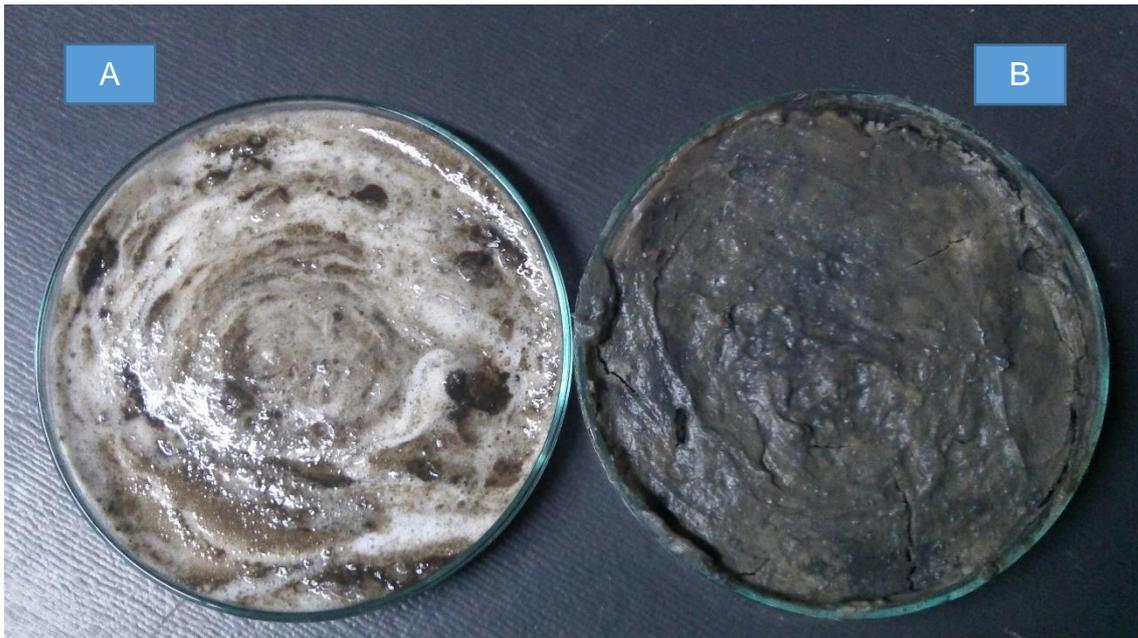
**Figura 3.17.** Lodos generados por la electrocoagulación de las aguas residuales antes (A) y después (B) de ser secados
