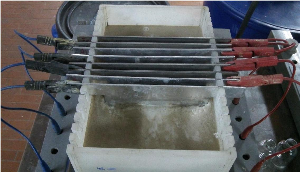
**Figura 3.14.** Celda utilizada en los ensayos de electro coagulación con 1,5 cm de distancia entre electrodos
