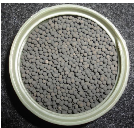
Figura 3.1. Fotografía del catalizador de la unidad de CCR gastado en forma de pellets
