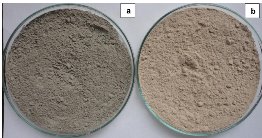
Figura 3.4. Fotografía comparativa del catalizador pulverizado (a) sin tratamiento térmico (b) con tratamiento térmico
