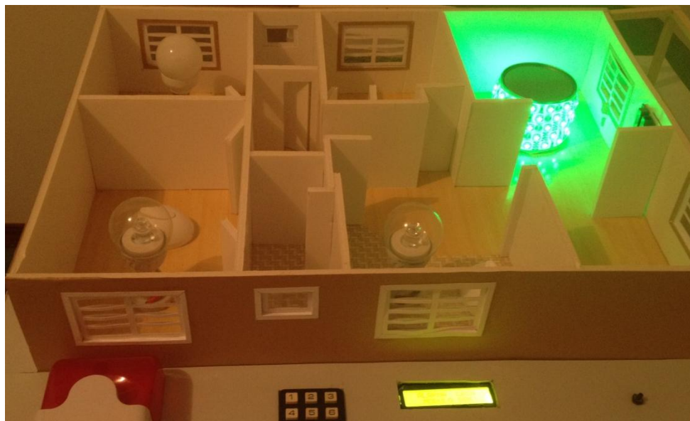
Figura 2.72. Foco 3 apagado por mensaje de texto
