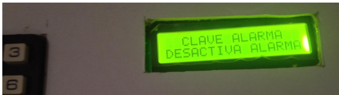
Figura 2.47. Pantalla del LCD indicando que la alarma esta desactivada
