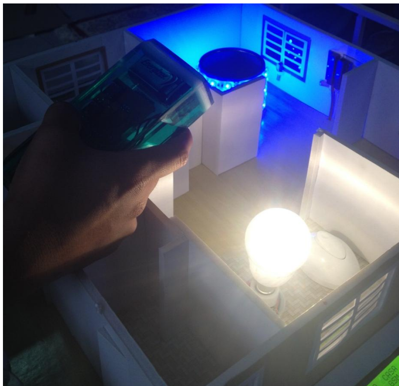
Figura 2.37. Pulsador 3 del control remoto (Foco 3 encendido)
