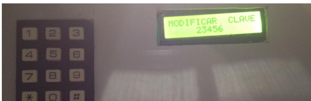
Figura 2.60. Pantalla del LCD cuando se guarda la nueva clave
