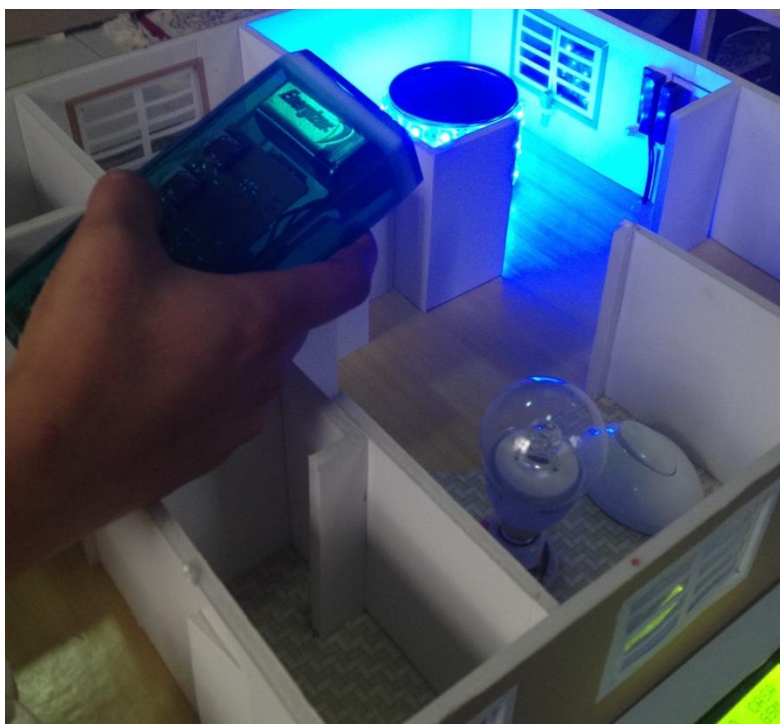
Figura 2.36. Pulsador 3 del control remoto (Foco 3 apagado)
