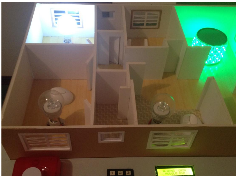
Figura 2.62. Foco 1 encendido por mensaje de texto
