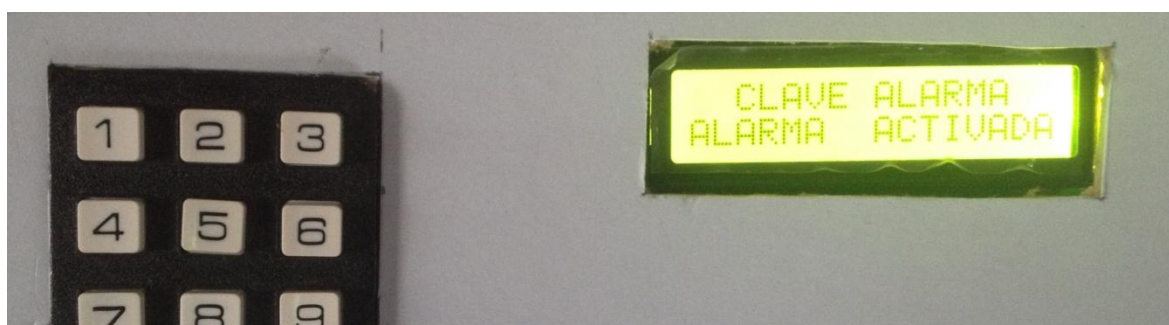
Figura 2.46. Pantalla del LCD indicando que la alarma esta activada
