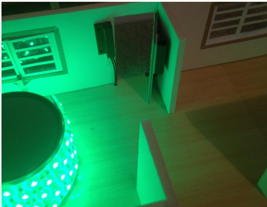
Figura 2.48. Sensores de puertas abiertos
