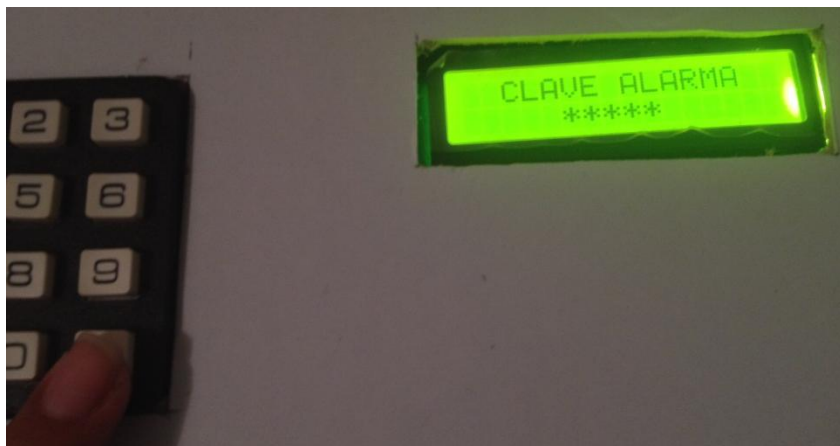
Figura 2.45. Pantalla del LCD con la clave para activacion o desactivacion de la alarma
