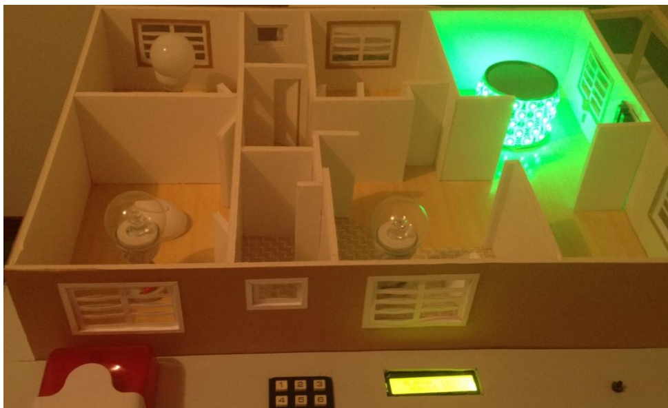
Figura 2.64. Foco 1 apagado por mensaje de texto
