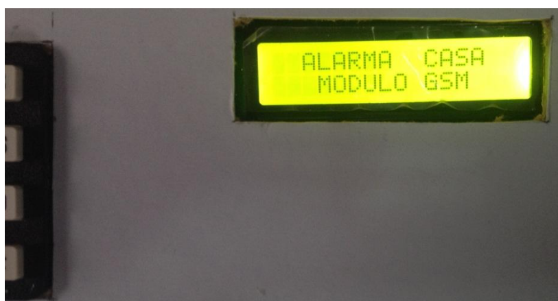
Figura 2.28. Pantalla del LCD con mensaje de Bienvenida
