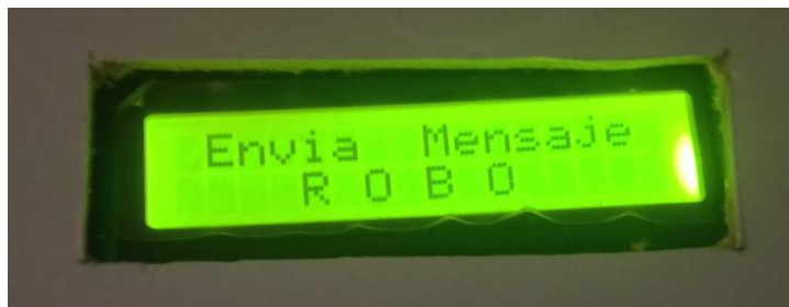
Figura 2.50. Pantalla del LCD cuando se envia el mensaje de alerta de robo
