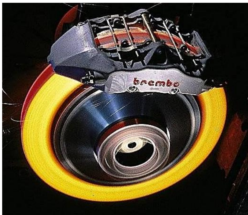
Figura 1.4 Calentamiento del Disco de Freno por acción de la Fuerza de Rozamiento
