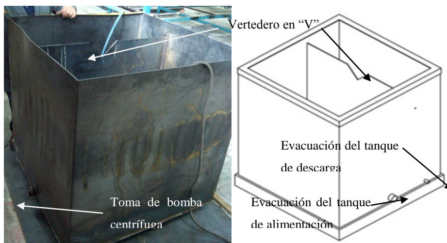
Figura 2.6. Tanque de alimentación y descarga
