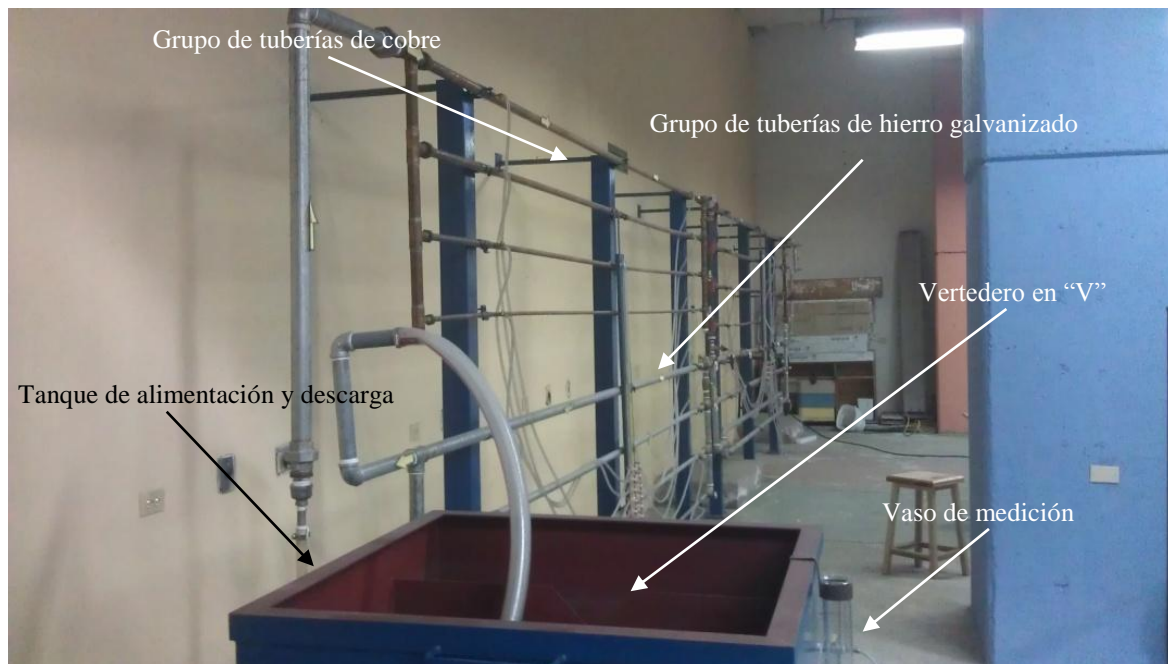
Figura 3.2. Grupos de tuberías de cobre y hierro galvanizado, tanque de alimentación y descarga con vertedero en “V” y vaso de medición
