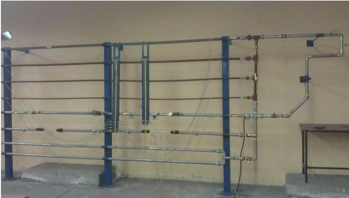
Figura 3.3. Grupo de tuberías de PVC, grupo de accesorios: válvulas, codos, expansión y contracción súbita, Venturi y tuberías en paralelo.
