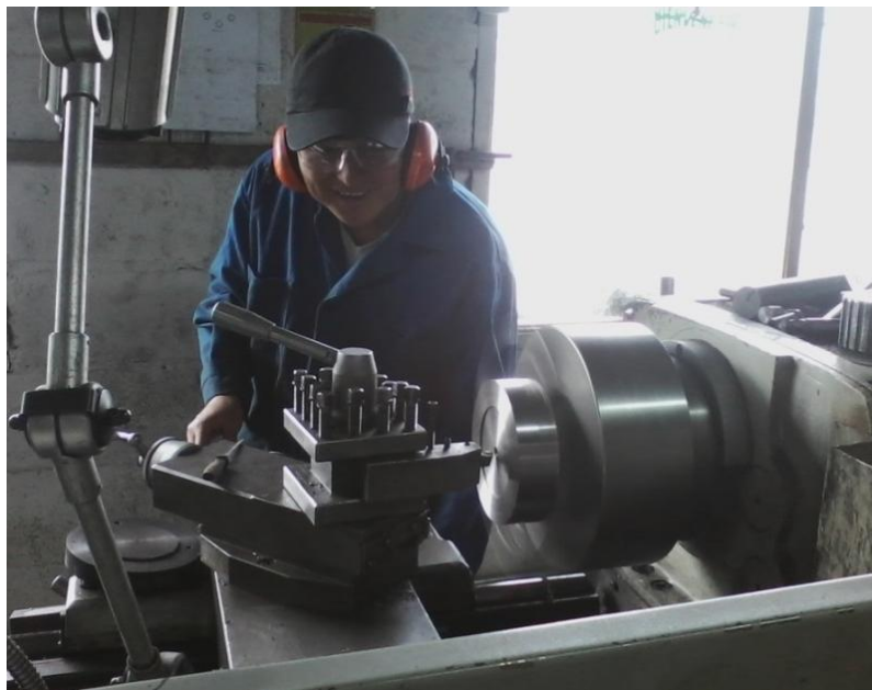
Figura 4.8 Construcción de placa sufridera
