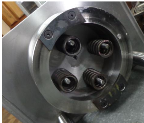
Figura 4.25 Montaje de resortes expulsores con mayor fuerza elástica
