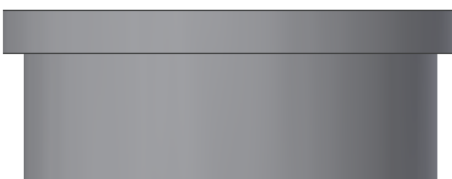
Figura 3.5 Punzón circular con cabeza mecanizada y perfil constante
