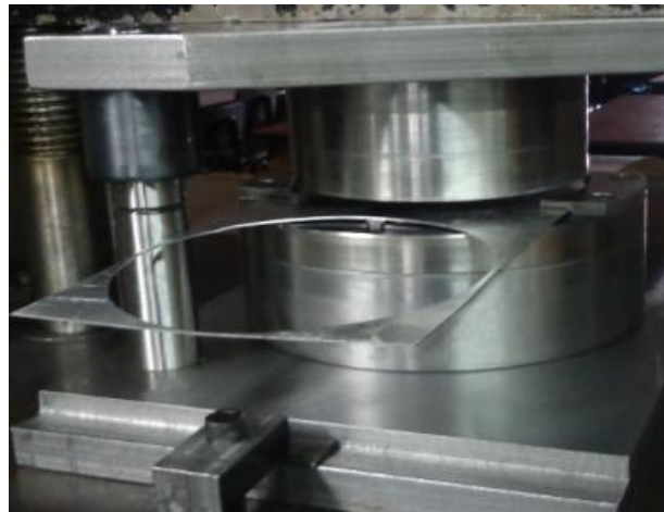
Figura 4.27 Funcionamiento adecuado del tope limitador longitudinal
