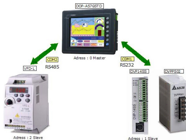
Figura 2.10. Vareador de frecuencia, PLC y pantalla táctil. 31
