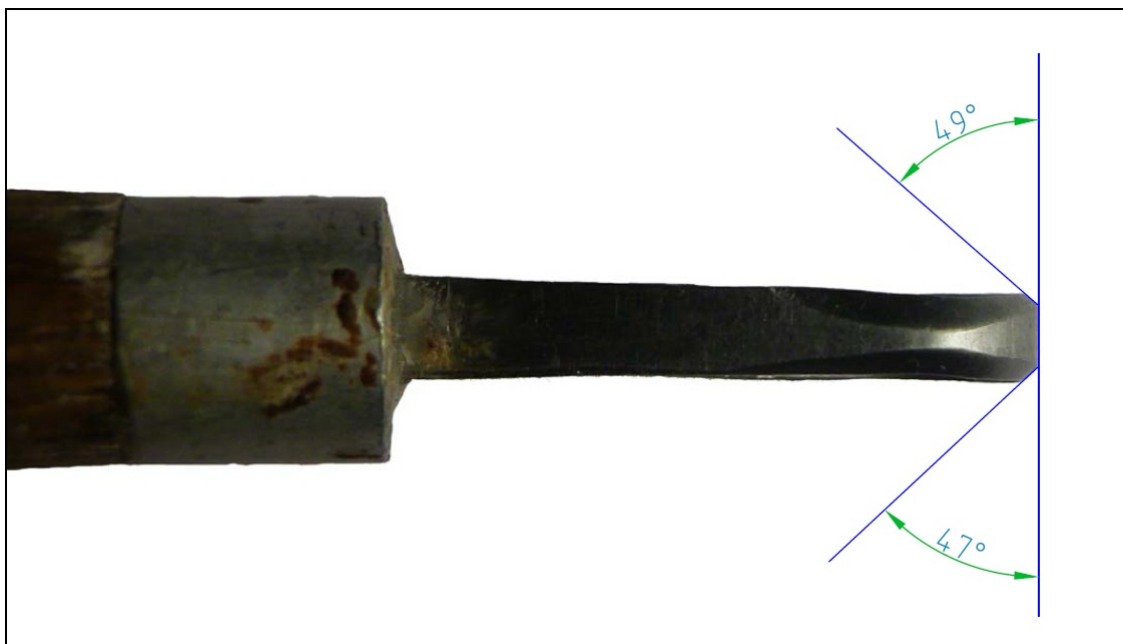
Figura 3.25. Ángulos de filo de la herramienta.
