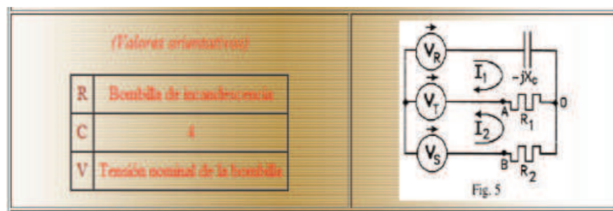
Fig.1.14. Circuito para detección de secuencia de fases método dos lámparas (con condensador). [15]
