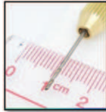
Fig.3.14. Mini drill con broca de 1mm. [82]
