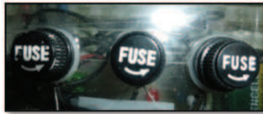
Fig.3.22. Portafusibles sobre la cubierta superior. [87]
