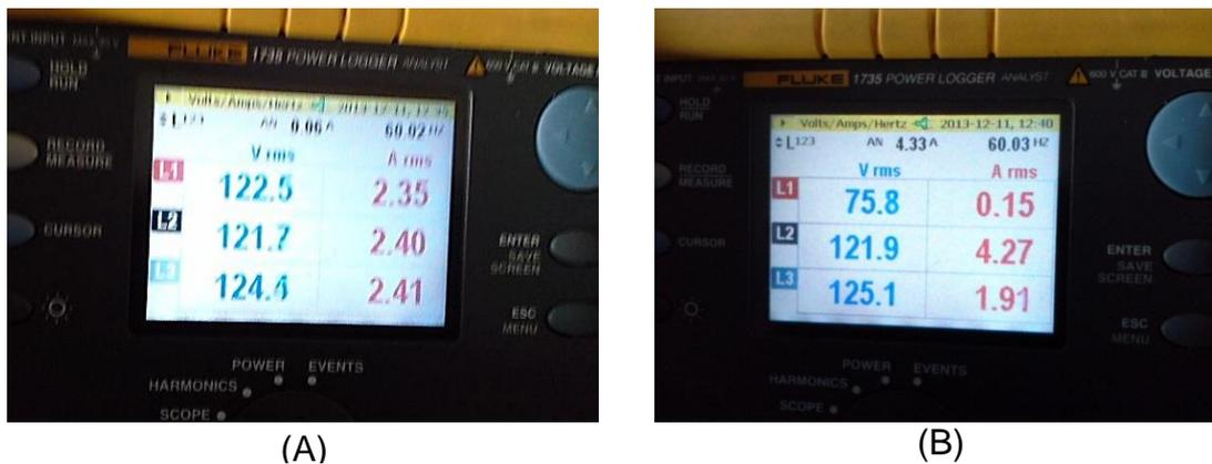
Fig. 4.6 Con carga 2.6A (A) Tres fases Energizadas (B) Fase A Desenergizada
