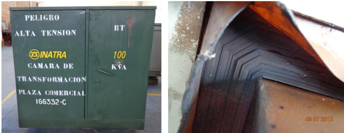
Fig. 4.9 Trasformador averiado INATRA
