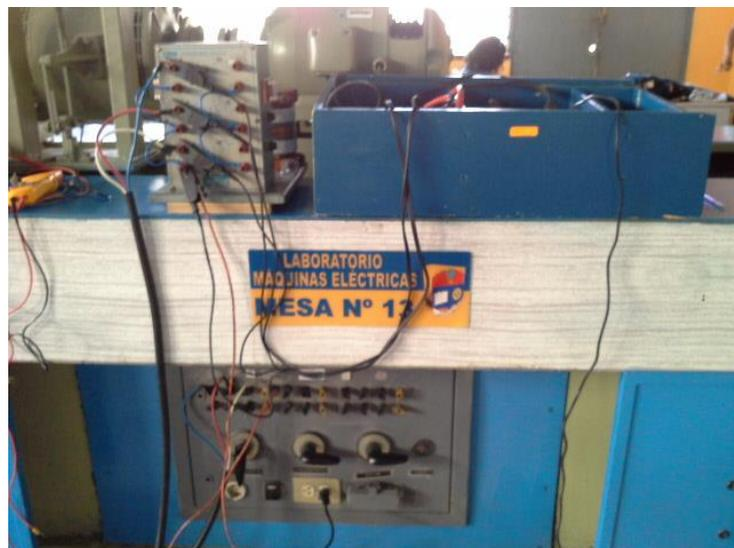
Fig. 4.2 Conexiones prueba transformador 3 columnas
