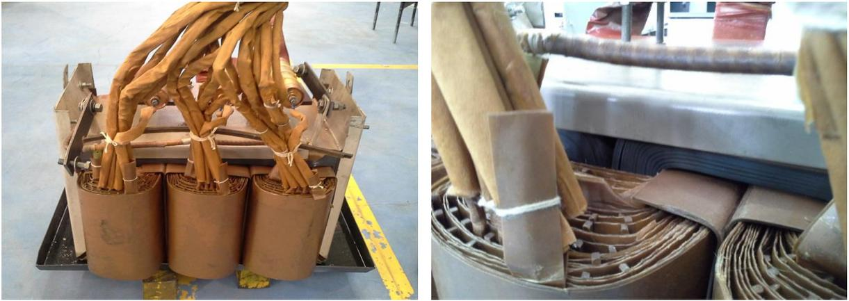
Fig. 1.7 Aislamiento Sólido de un transformador
