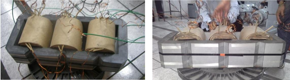
Fig. 4.8 Transformador de 5 columnas para pruebas
