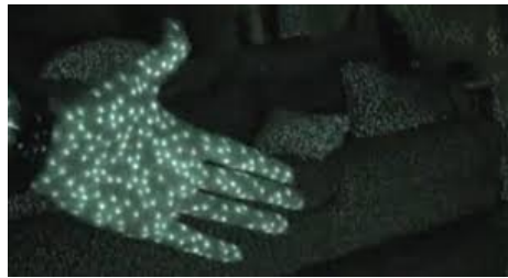
Figura 1.3 Malla de puntos de luz infrarroja que proyecta el kinect, tomado de [4]
