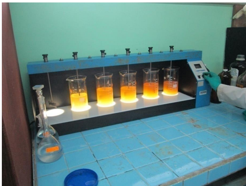
Fotografía 4.1: Acondicionamiento de lodos con polímero
