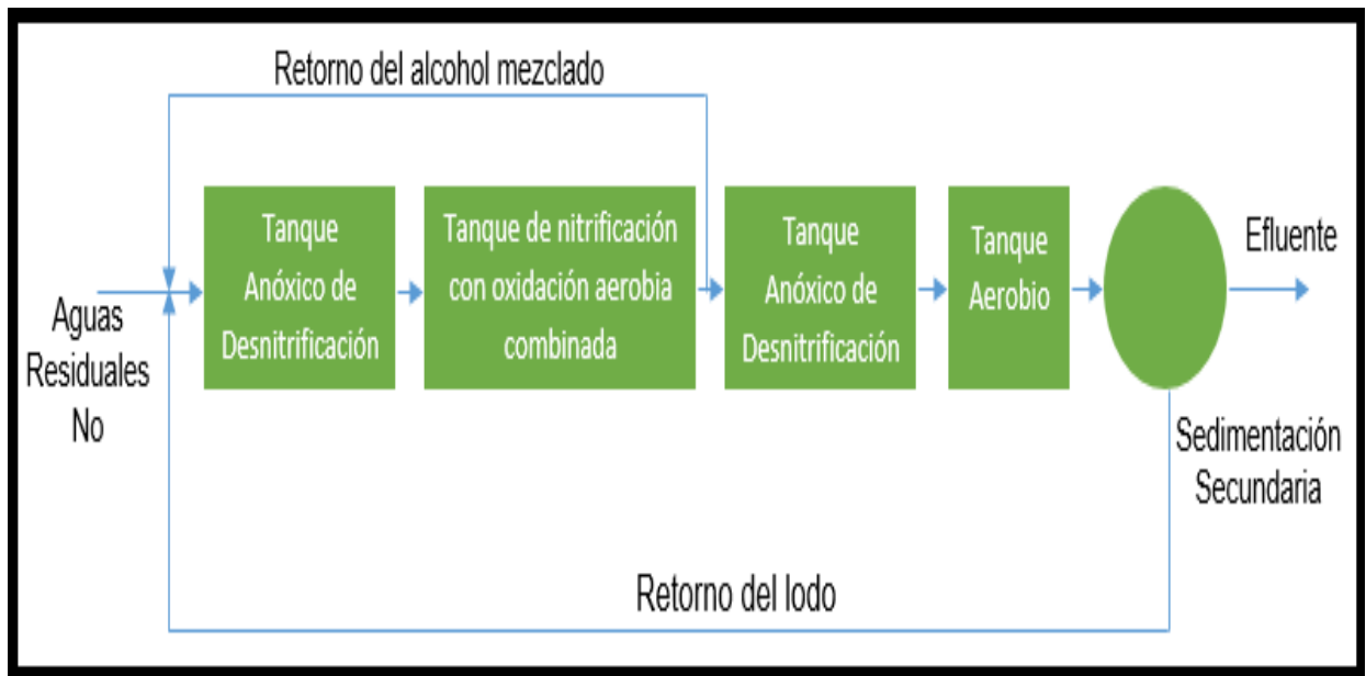
GRÁFICO 2.3: EL SISTEMA SECUENCIAL BARDENPHO CON USO DE CARBÓN ORGÁNICO PRESENTE EN EL AGUA RESIDUAL Y DEL CARBÓN ENDÓGENO.
