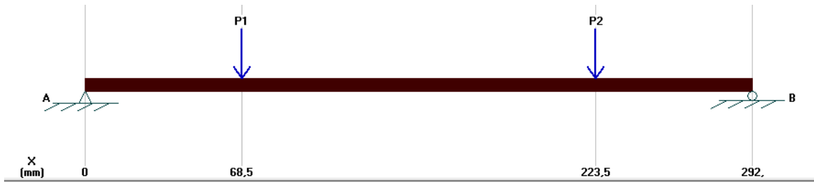
Figura 4. 9: Diagrama de cuerpo libre del eje
