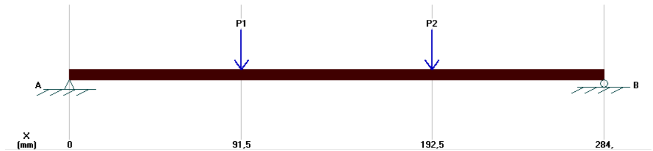
Figura 4. 15: Diagrama de cuerpo libre del eje en el plano Z-Y
