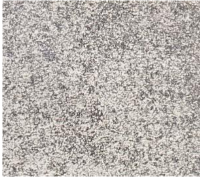
Figura 1. 12: Grado “C” preparada con un nivel de preparación de superficie equivalente a SA 2 ½
