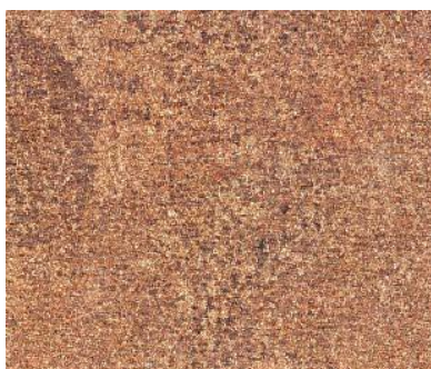
Figura 1. 5: Grado “B” preparada con un nivel de preparación de superficie equivalente a SA 1
