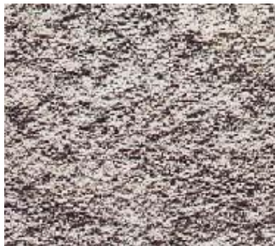
Figura 1. 9: Grado “C” preparada con un nivel de preparación de superficie equivalente a SA 2
