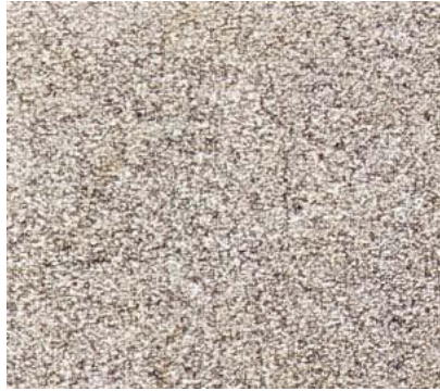
Figura 1. 14: Grado “B” preparada con un nivel de preparación de superficie equivalente a SA 3
