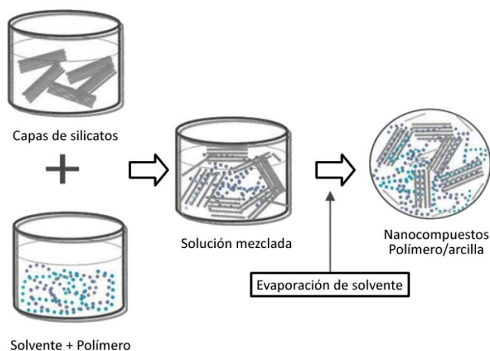
Figura 1.6. Representación esquemática de un nanocompuesto polímero/capas de silicato obtenido por el método de solución [14].
