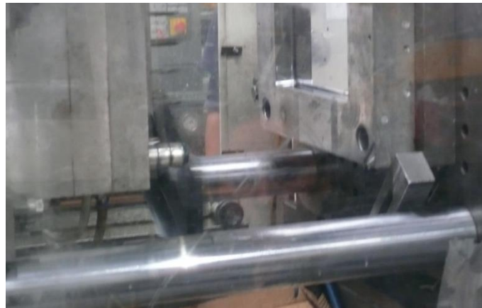
Figura 2.24. Montaje del molde de la bandeja de batería en la inyectora.
