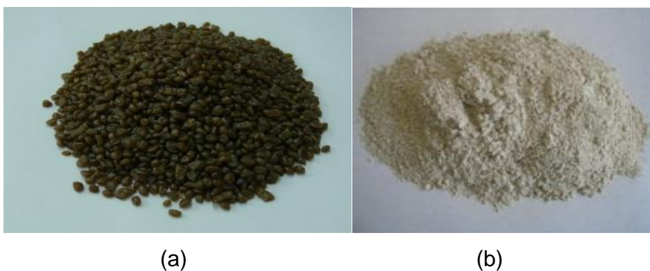
Figura 2.1. Arcillas monmorilloníticas: (a) arcillas en masterbatch y (b) arcillas en polvo.
