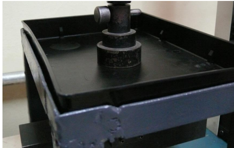
Figura 2.26. Montaje de la bandeja de batería para el ensayo de carga puntual.
