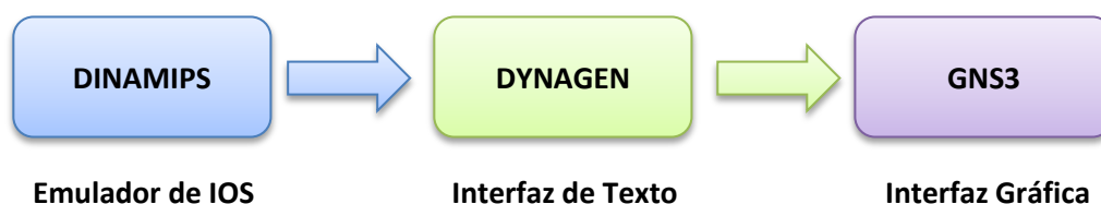
Figura 1.10: Estructura de GNS3
