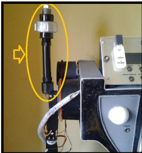
Figura 4.5 Sistema de contrapeso adherido al sistema robótico
