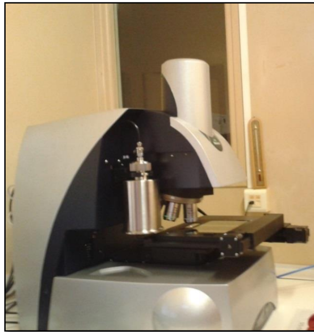
Figura 4-8 Equipo “Morphology G3” utilizado en el análisis morfológico de las cenizas de marzo y julio 2013.
