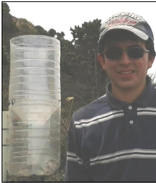
Figura 4-1 Cenizómetro casero instalado cerca de la estación de monitoreo Retu, ubicado a 3900 msnm en el flanco Norte del volcán Tungurahua.
