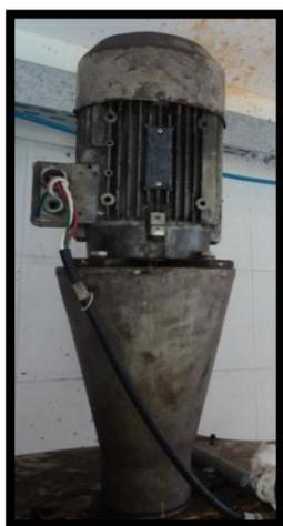
Figura: 9. Mezclador de ayudante de coagulación
