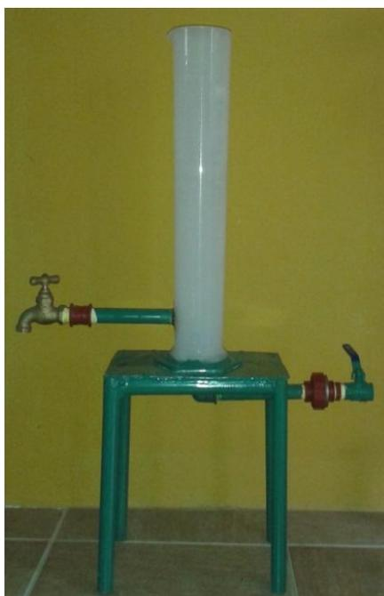
**Figura 3.2.** Tanque de Flotación
