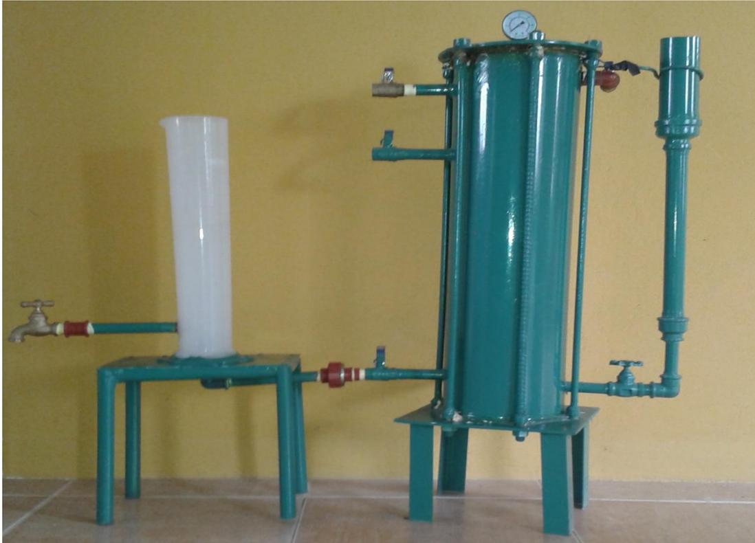
**Figura 3.3.** Sistema de flotación por aire disuelto a escala laboratorio
