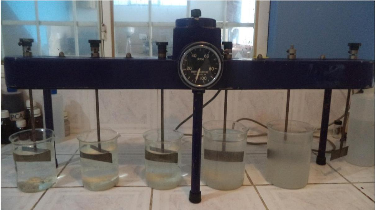
**Figura 3.12.** Prueba de jarras para una muestra del efluente con turbidez inicial de 186 (NTU) y pH 6.2
