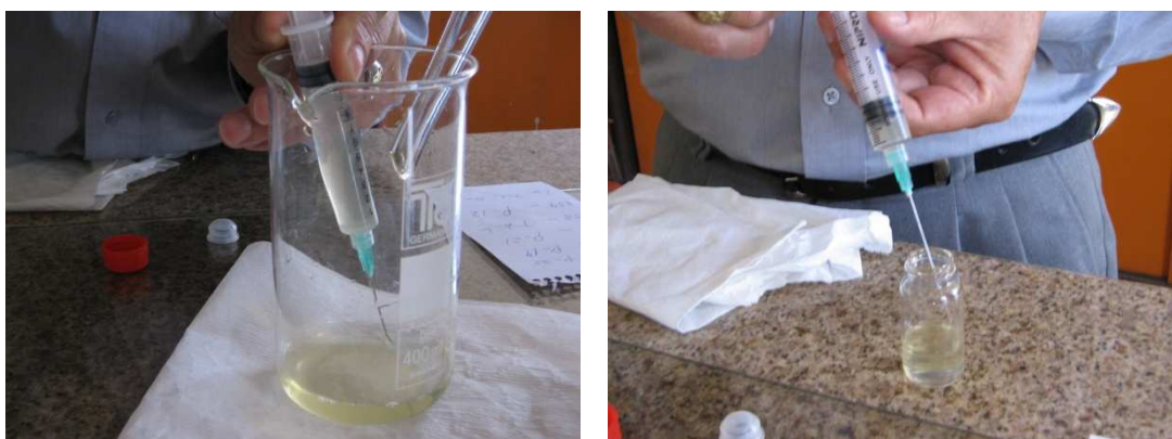
Figura 3.33: Se coloca 10 ml de agua filtrada en un vial.
