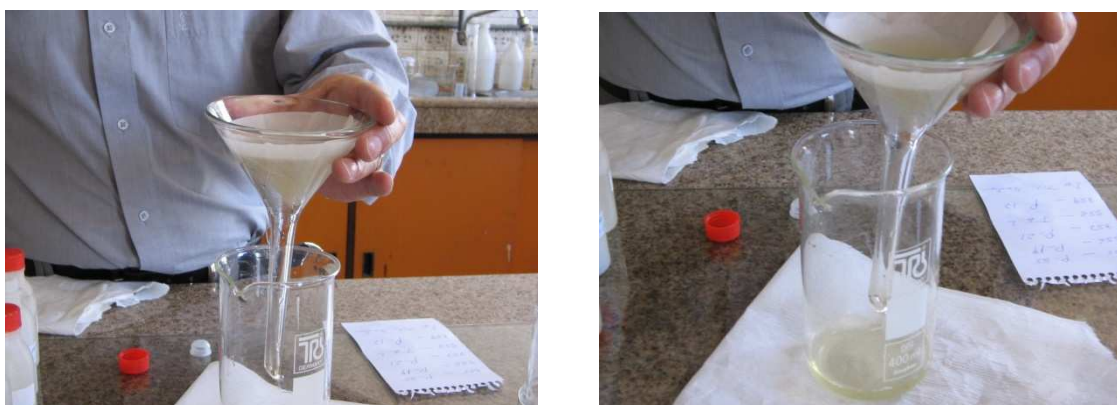
Figura 3.32: Se filtra la muestra de agua para quitar toda impureza.
