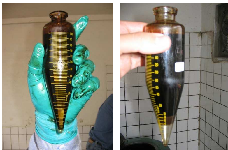
Figura 3.23: Volúmenes de agua obtenidos luego de colocar las 5 gotas de demulsificante en las muestras de los pozos PP-35 y PP-21.
