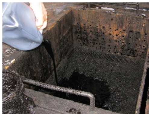
Figura 3.28: Se deposita el agua extraída en cada frasco rotulado y el crudo sobrante en los sumideros.
