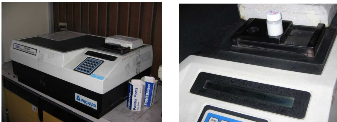
Figura 3.36: Se introduce cada vial en el contador de centelleo para su correspondiente lectura.
