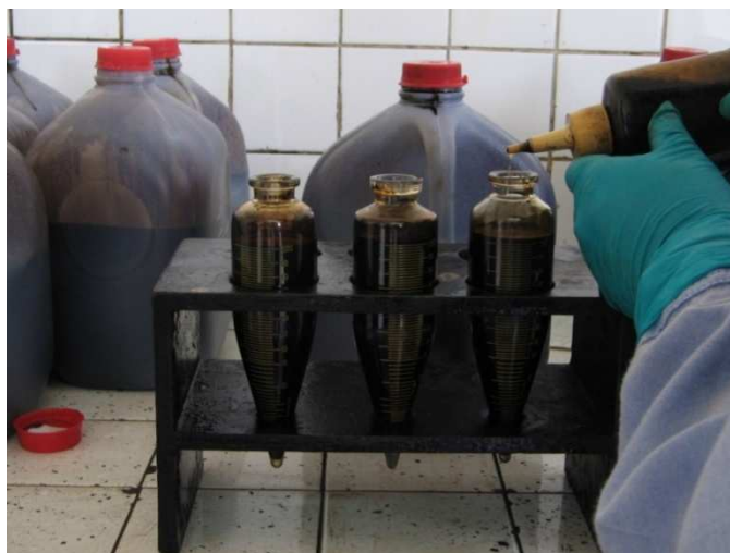
Figura 3.22: Se coloca demulsificante para romper la emulsión.
