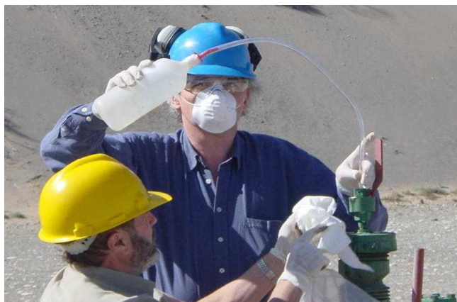
Figura 3.2: Incorporación del trazador al pozo inyector
