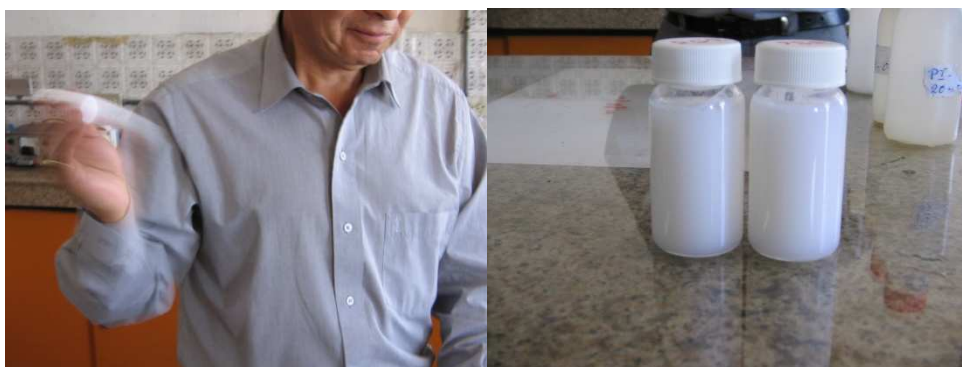
Figura 3.35: Se agita cada vial hasta obtener una mezcla homogénea.
