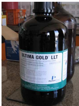
Figura 3.34: Se añade 10 ml de coctel centellador.
