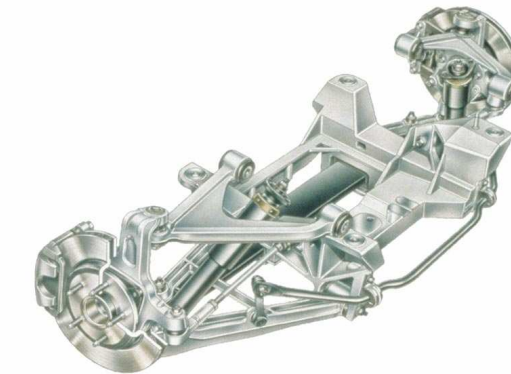
Figura 1.6. Ballesta transversal de la suspensión delantera independiente del Corvette C5 fabricada con fibra de carbono y epoxi. [1.7]
