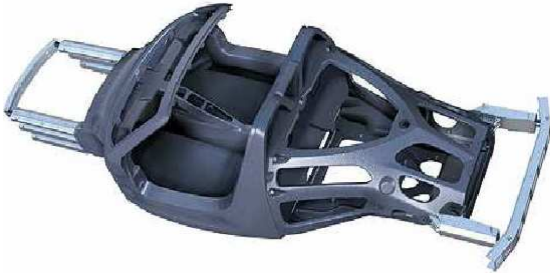
Figura 7.5. Chasis de fibra de carbono/epoxi del Porsche Carrera GT. [7.5]
