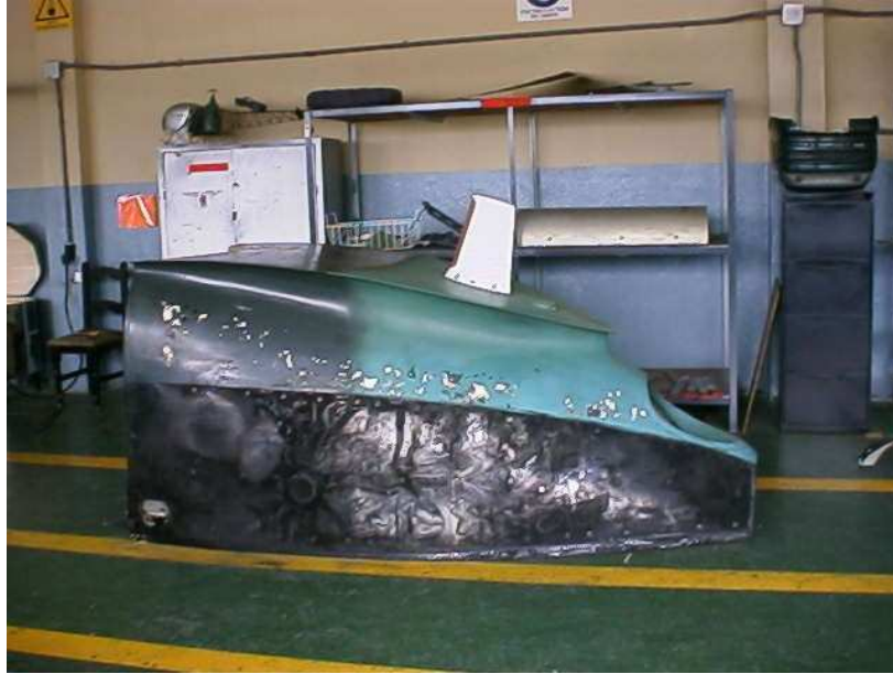
Figura 1.11. Cubre-motor en reparación del helicóptero PUMA, fotografía tomada en los talleres del 15-BAE.
