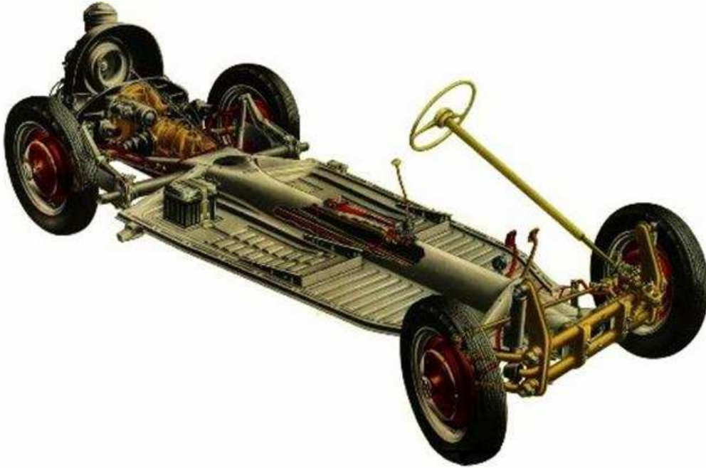
Figura 7.7. Chasis tipo columna vertebral del Volkswagen escarabajo. [7.7]
