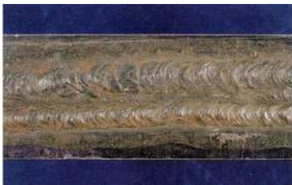
27 Figura 2-10. Cordones Defectuosos
