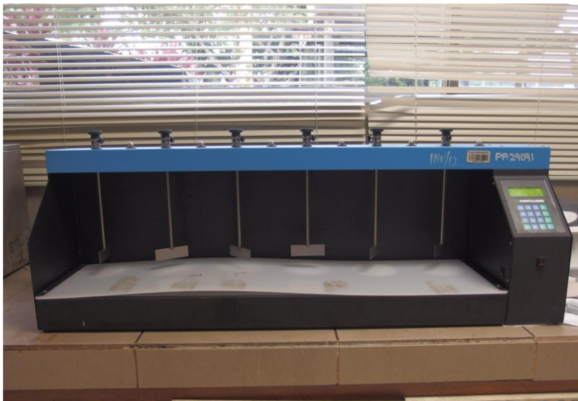
Figura 2.3. Equipo de prueba de jarras
