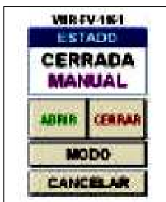
Figura No 7.16. Pantalla de Estado de Válvula de Descarga de agua del Tanque de Reposo.
