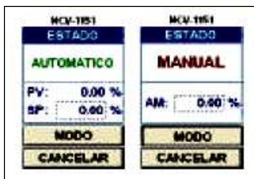
Figura No 7.15. Pantallas de Estado de Válvula Proporcional.
