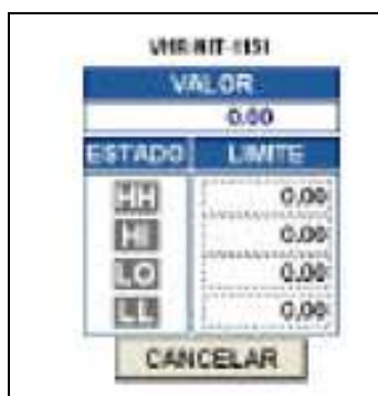
Figura No 7.8. Pantalla de Alarmas para variables análogas.
