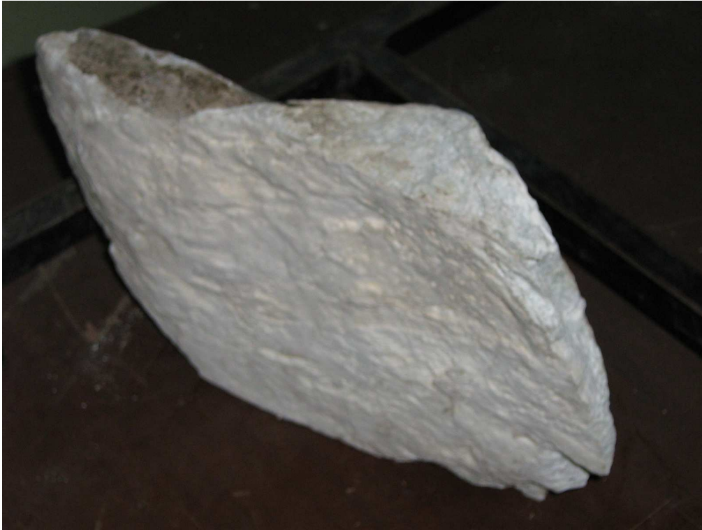
Foto 8. Muestra de mano de la parte central del área minera “La Ercilia”. (UTM: 693250E; 9847550N). Contacto transicional entre la dacita y el cuerpo albitizado.
