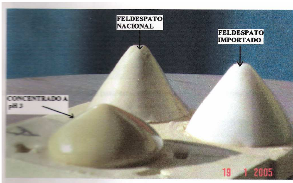
Fig 10. Conos pirométricos del feldespato La Ercilia “Feldespato Nacional”, el cual es comparado con el cono resultante de l feldespato importado. Tomado de Júa (2005).
