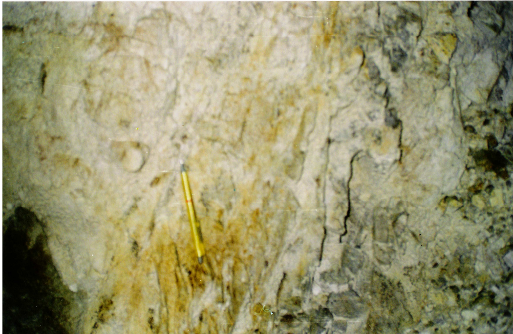
Foto 14. Parte sureste del banco de explotación 2 (UTM: 693305E; 9847485N). Xenolito de la formación Macuchi en el Área Minera “La Ercilia”. En el extremo derecho de la foto se puede apreciar la propilitización que sufre el cuerpo albitizado.
