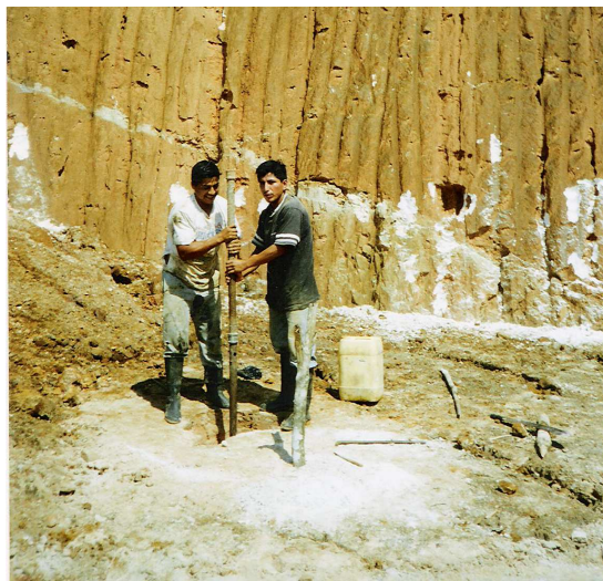
Foto 11. Pozo manual 1 (UTM: 693356E; 9847355n). Realización de una perforación manual, con el equipo Auger.
