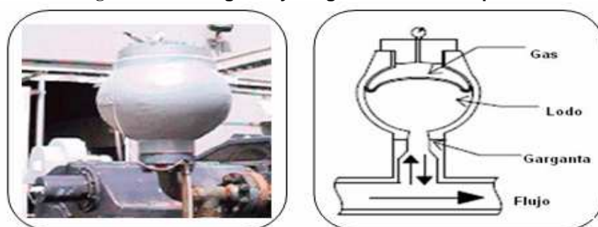
Figura 1.18: Fotografía y Diagrama de un dampener
