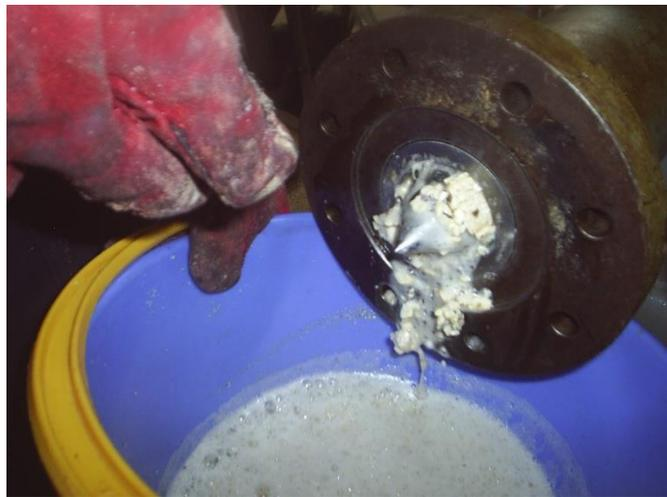
**Figura 2.7.** Recolección del aceite a la salida del extrusor
