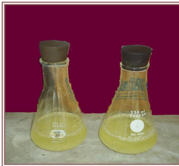
**Figura AVII.3.** Determinación de celulosa
