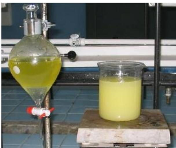
**Figura AII.3.** Separación del biodiesel del agua de lavado y mezcla de biodiesel con agua.
