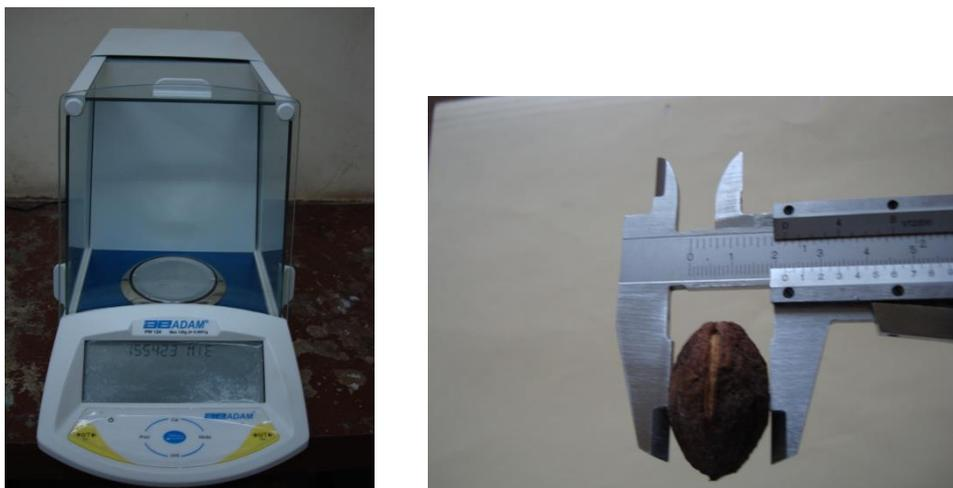
**Figura 2.2.** a) Balanza Analítica b) Calibrador, empleados para determinar las propiedades físicas del fruto y la semilla
