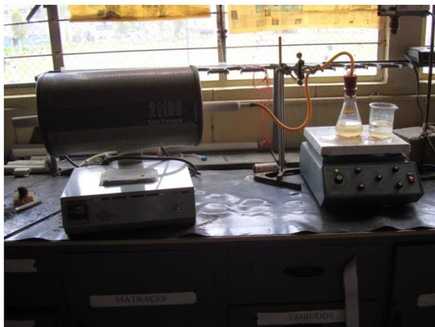
**Figura 2.12.** Horno tubular Thermolyne, para realizar la activación de carbón
