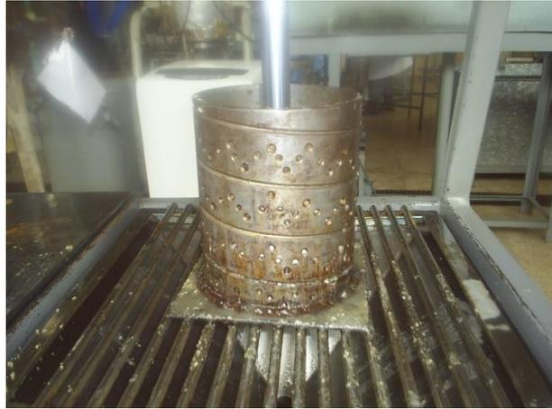
**Figura 2.8.** Prensa Hidráulica para extraer el aceite parte del aceite del residuo.
