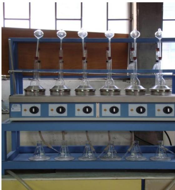
**Figura AV.2.** Equipo de destilación
