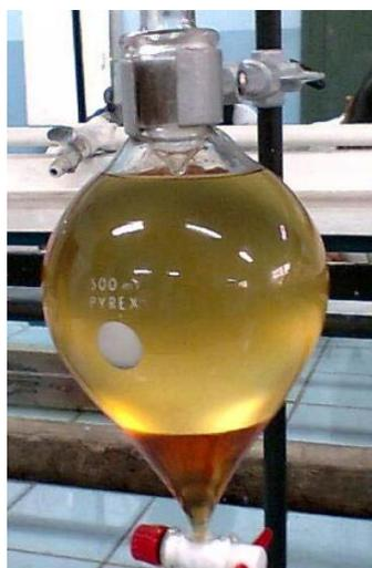
**Figura AII.2.** Separación del biodiesel de la glicerina.
