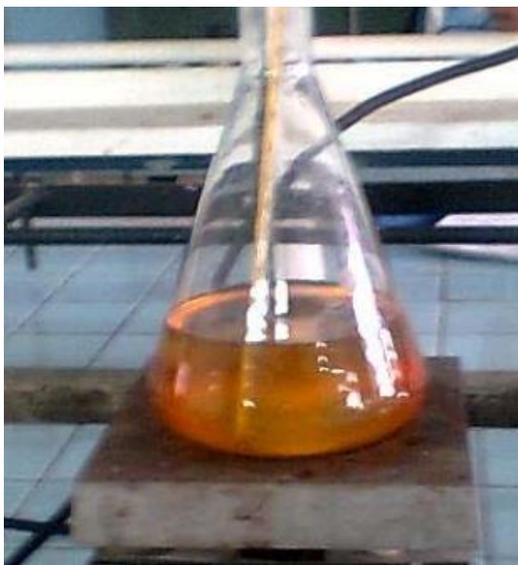
**Figura AII.1.** Biodiesel obtenido con metanol e hidróxido de sodio
