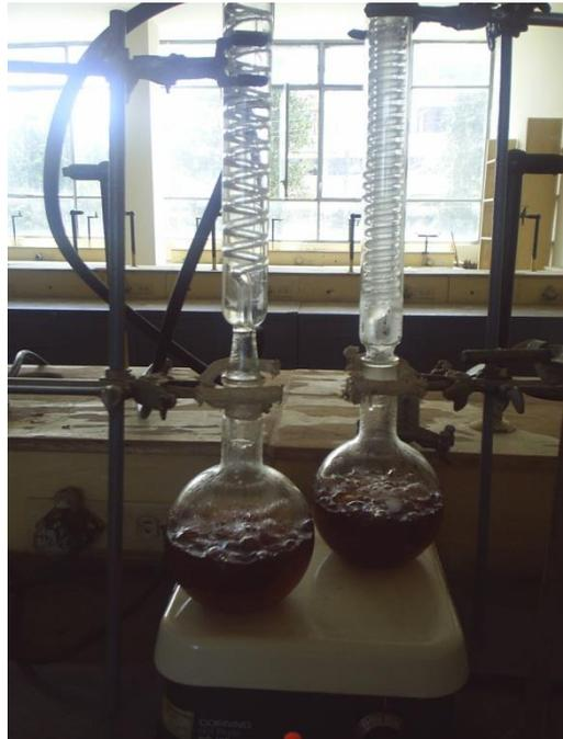
**Figura AVII.2.** Equipo de reflujo con plancha de calentamiento para determinación de lignina
