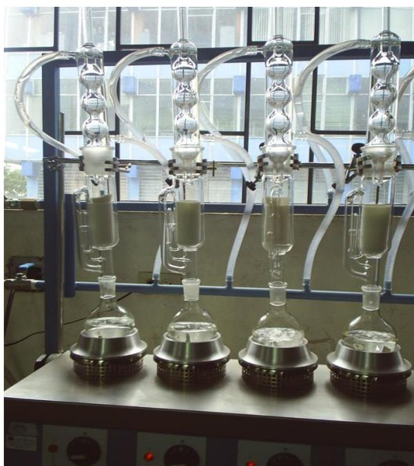
**Figura AVII.1.**Equipo Soxhlet para determinación de ceras y grasas
