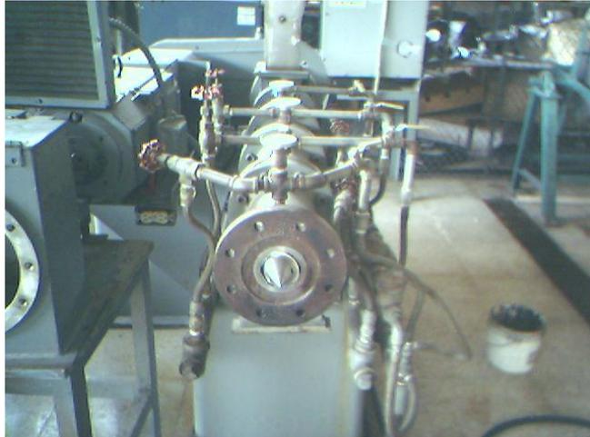
**Figura 2.6.** Extrusor marca Bonnot, empleado para la extracción del aceite
