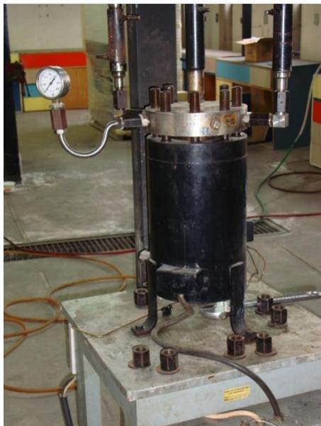
**Figura AII.6.** Reactor empleado para la transesterificación a 250°C y 18 atm
