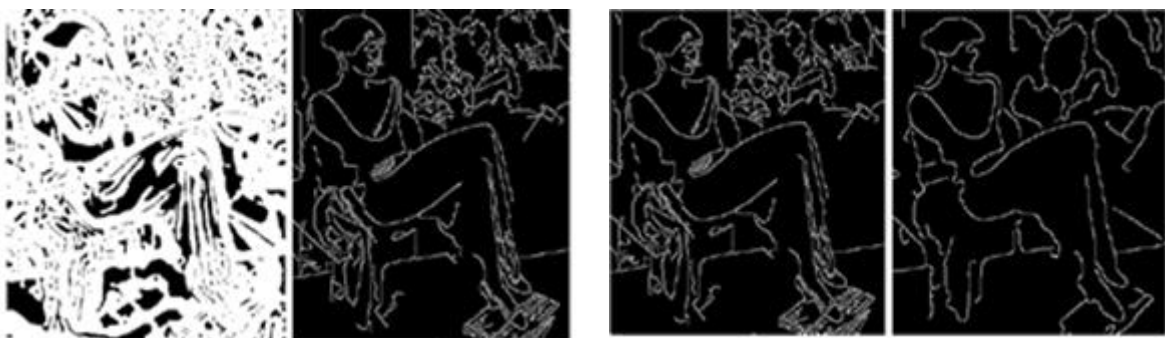
Figura.2.29 Resultado algoritmo de Cany para diferentes valores de umbrales [36]
