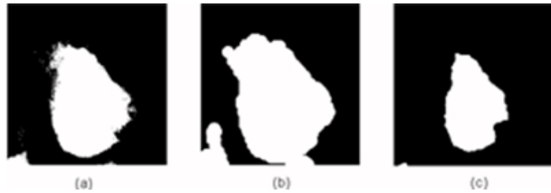
Figura.2.18 (a) Imagen original, (b) Imagen dilatada, (c) Imagen erosionada [9]
