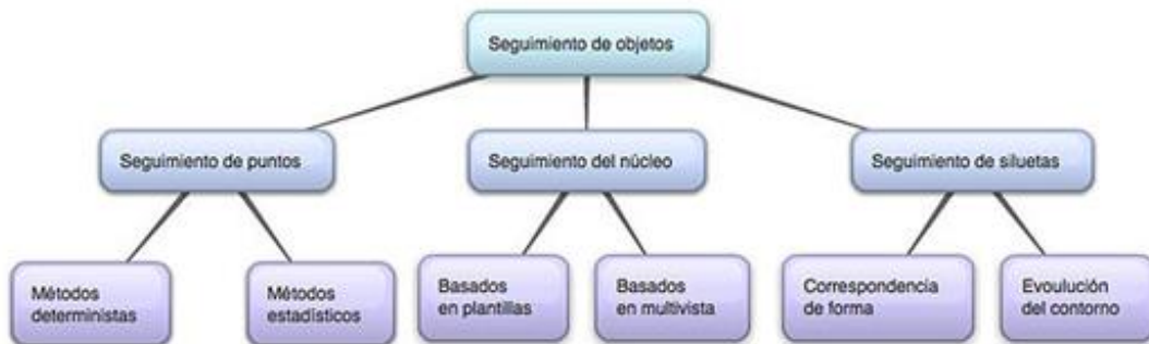
Figura.1.31 Esquema de las diversas técnicas utilizadas para realizar el seguimiento de objetos [24]
