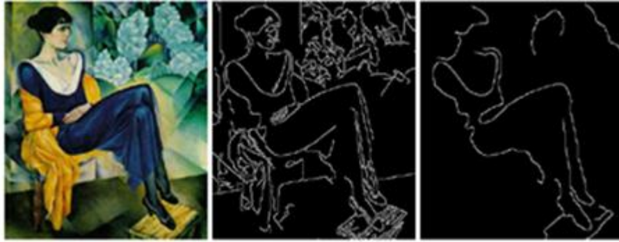
Figura.2.26 Resultado del algoritmo de Canny con diferentes suavizados [36]
