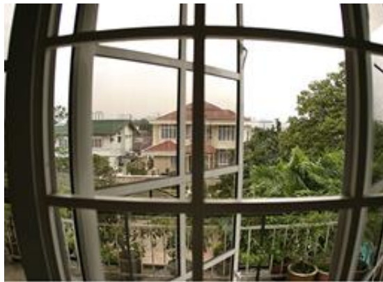
Figura.2.1 Distorsión de la imagen por la lente de la cámara [31]
