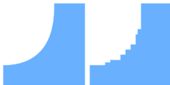
Figura.2.5 Comparación de una región curva descrita mediante una imagen vectorial con una descrita por un mapa de bits [9]
