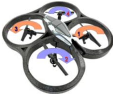
Figura.3.19 Descripción del vuelo del Ar.Drone 2.0 [40]
