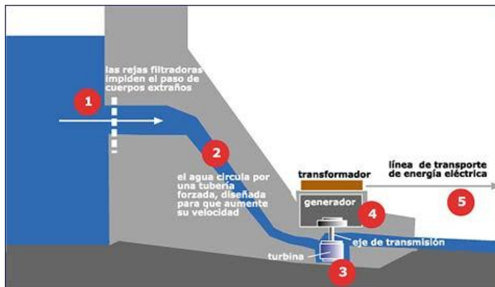
Gráfica 3.16 Esquema de una central hidroeléctrica.
