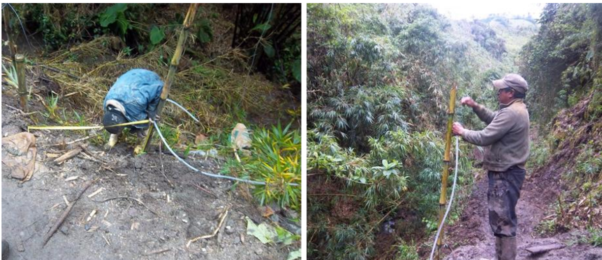
Gráfica 4.33 Medición de la altura empleando el método de la manguera de nivelación.
