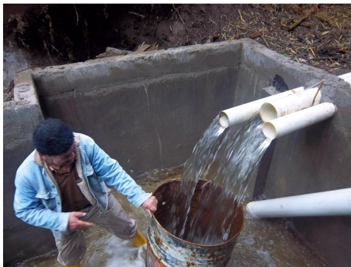
Gráfica 4.34 Medición del caudal empleando el método del recipiente
