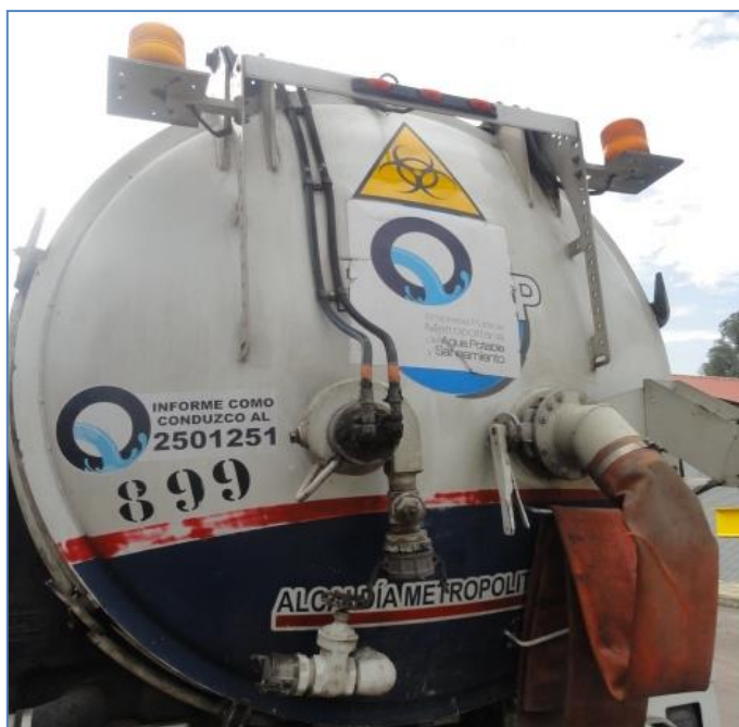
Figura 3.16. Fotografía que muestra la implementación de señalética de advertencia colocada en la parte posterior del camión educor
