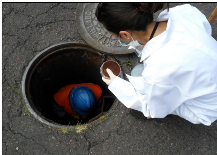
Figura 2.2. Fotografía que muestra la obtención de muestras de ambiente de alcantarillado para su posterior cultivo (Cajas de agar)
