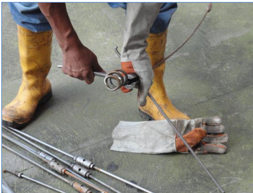
Figura 1.7. Fotografía que muestra el ensamble de una herramienta rotativa y una varilla utilizada para desobstrucción de cañerías
