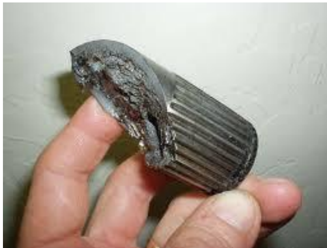
Figura 2.4. Material con fractura por pérdida de tenacidad
