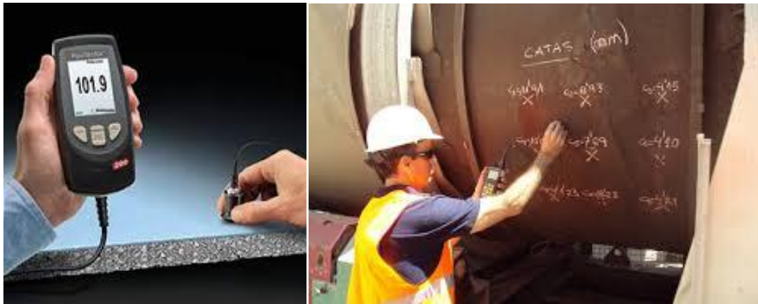
Figura 2.13. Medición de espesores por ultrasonido
