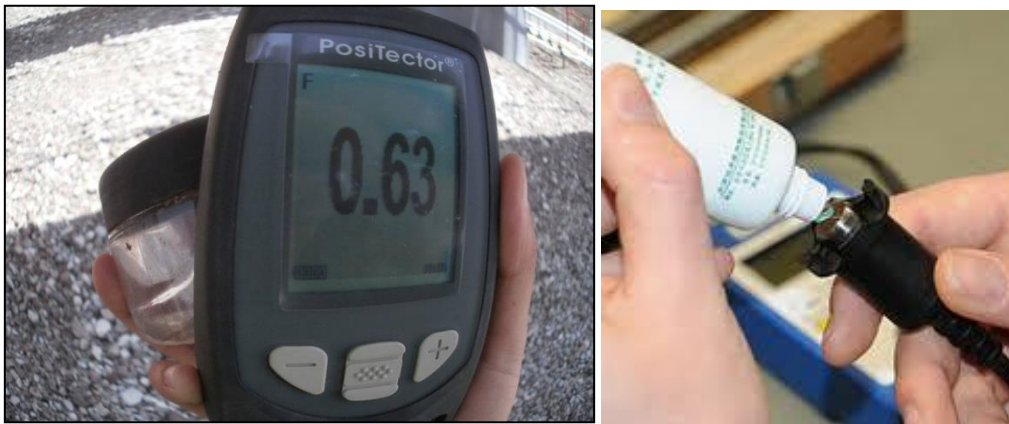
Figura 3.7. Medidor de espesores por ultrasonido y gel acoplante
