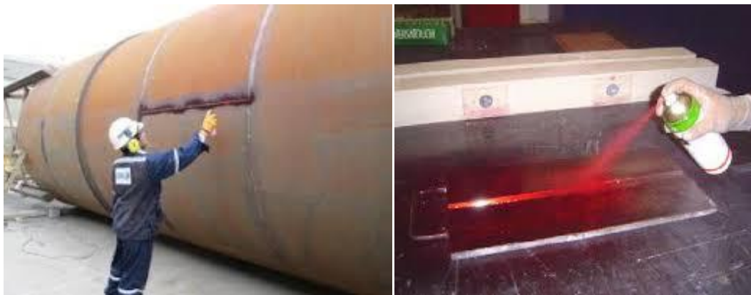
Figura 2.14. Inspección por líquidos penetrantes
