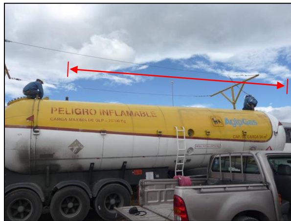
Figura 3.16. Toma de dato de la medida de longitud de un tanque horizontal
