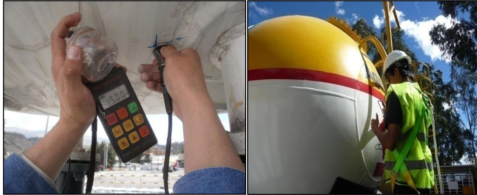
Figura 3.8. Medición de espesores por ultrasonido de planchas de acero
