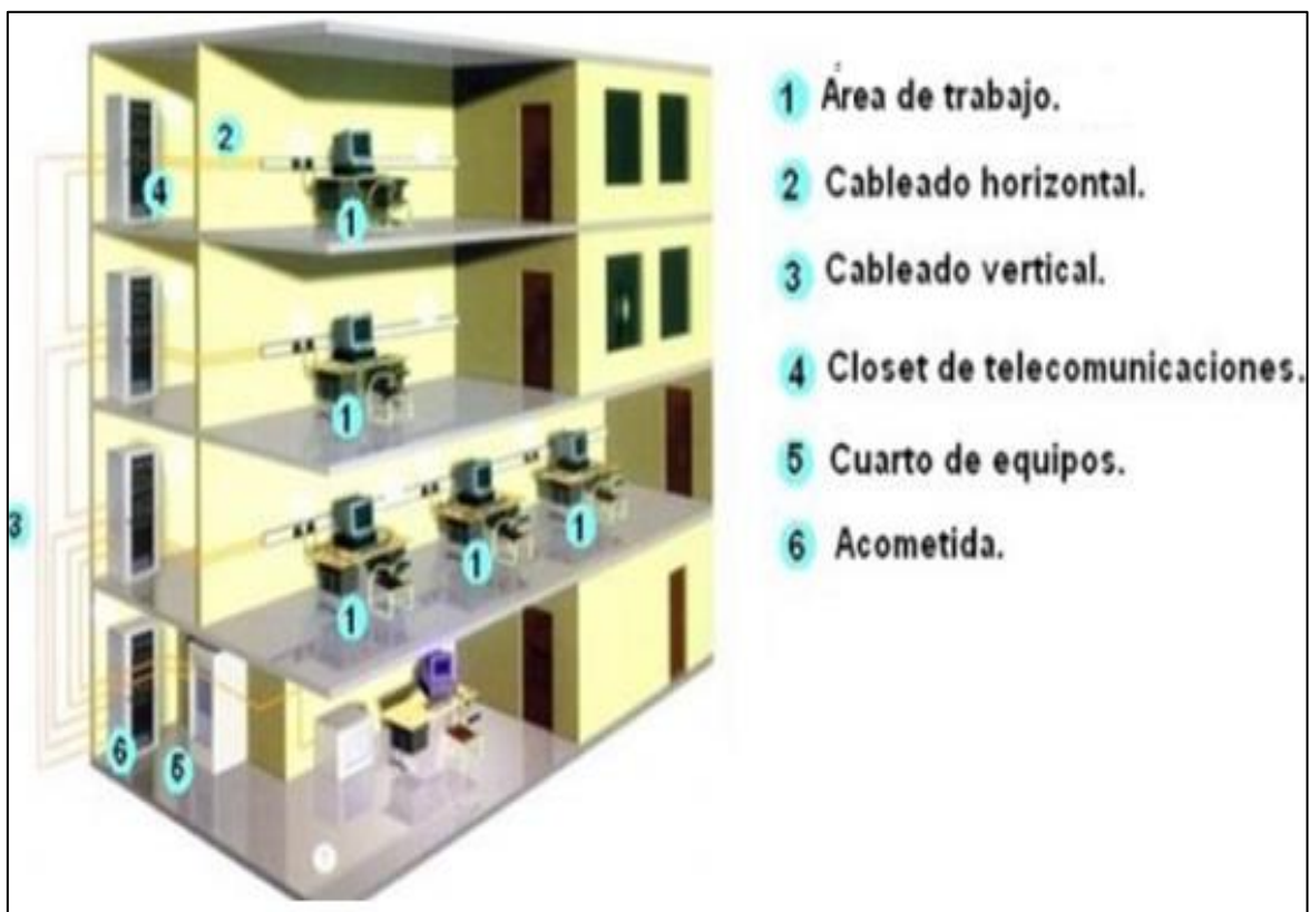
Figura 1. 23 Subsistemas del sistema de cableado estructurado [37]
