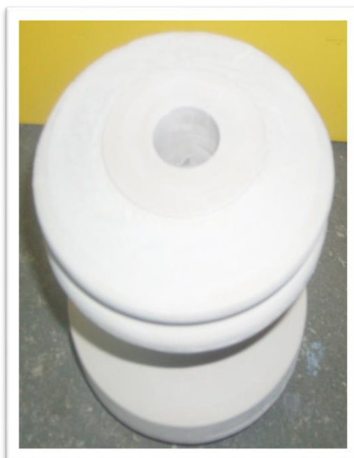
Figura 3.17: Aisladores después del ciclo de cocción.
