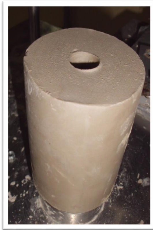
Figura 3.15: Orificio de la barra extruida.
