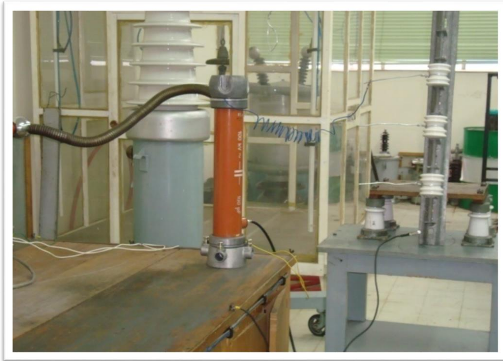
Figura 4.3: Equipo usado en el ensayo de tensión de flameo en seco.
