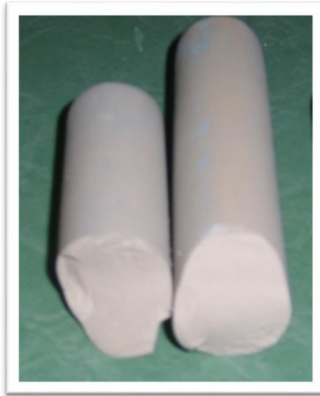
Figura 3.8: Verificación de porosidad en las probetas de pasta cerámica.
