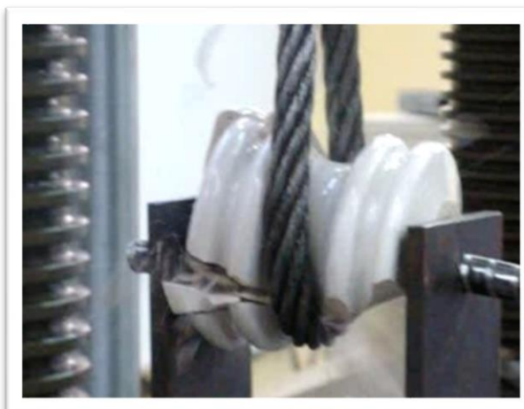
Figura 4.2: Momento de la fractura en el ensayo de resistencia transversal
