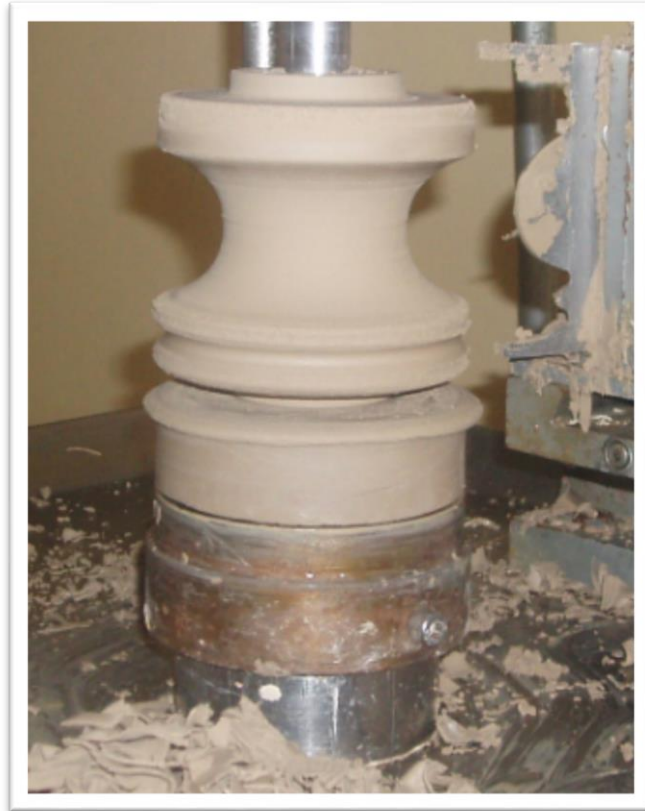
Figura 3.16: Aislador formado en el torno.
