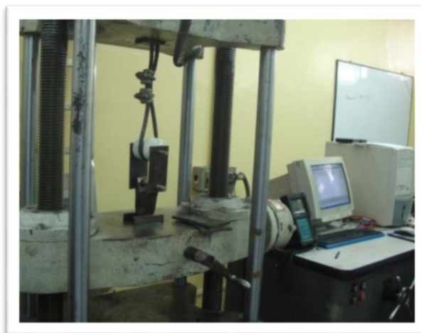
Figura 4.1: Ensayo de resistencia mecánica transversal de los aisladores
