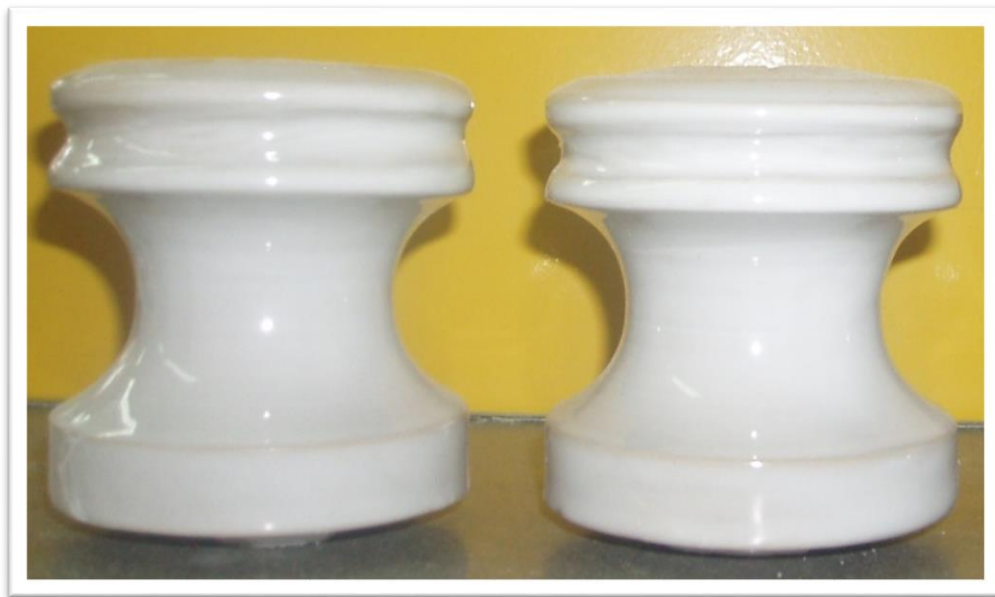
Figura 3.18: Aisladores ANSI 53-2 terminados.
