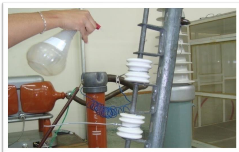
Figura 4.4: Montaje vertical para el ensayo de tensión de flameo en húmedo.
