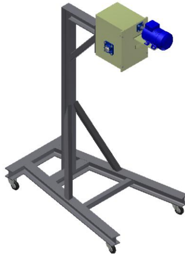
Figura 3. 5. Estructura tipo Pluma (Fuente: Propia)
