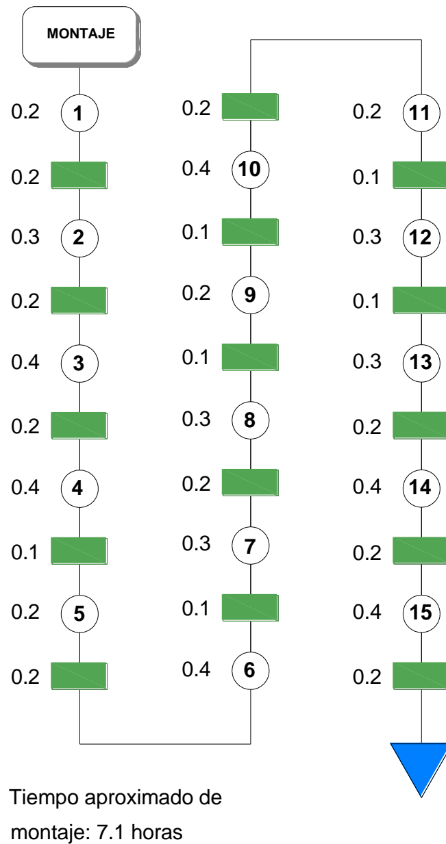
Figura 5. 6. Diagrama de flujo del Montaje del Elevador. (Fuente: Propia)
