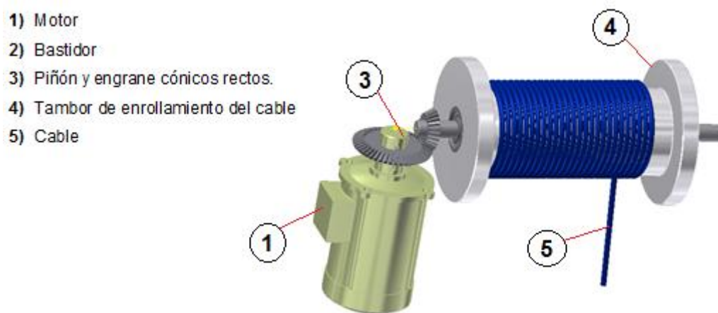
Figura 3. 2. Sistema mecánico de engranes cónicos rectos, tambor y cable.
