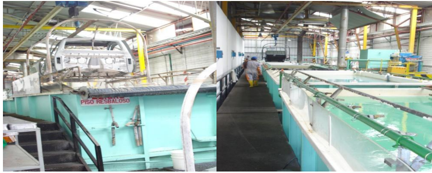
Figura 3.8. Proceso de Desengrase y Fosfatizado
