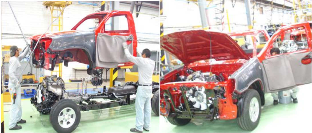
Figura 3.12. Proceso de Vestidura de cabinas
