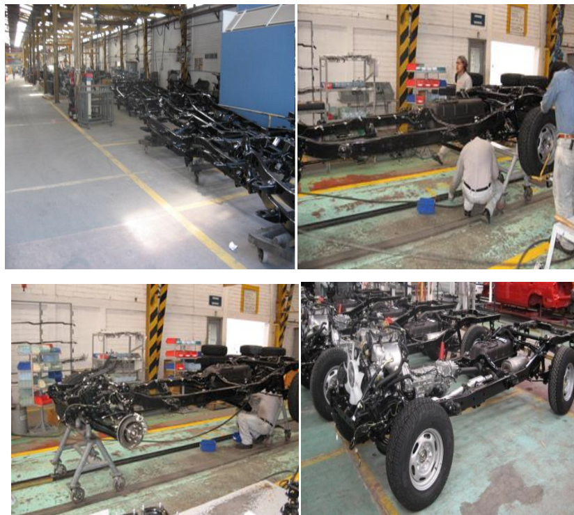
Figura 3.11. Proceso de Vestidura de chasis
