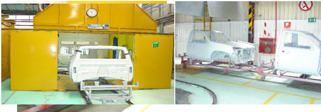
Figura 3.9. Proceso de Aplicación de fondo y sellado
