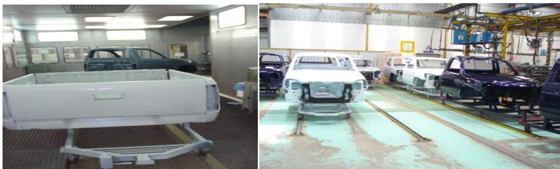
Figura 3.10. Proceso de Aplicación de color y retoques
