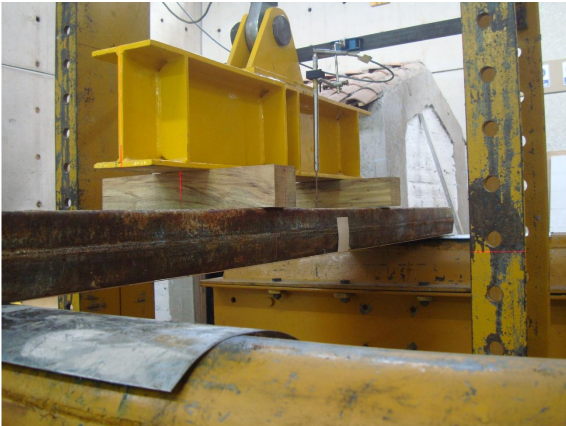
Fotografía 7: Sistema de carga y deformación del experimento
