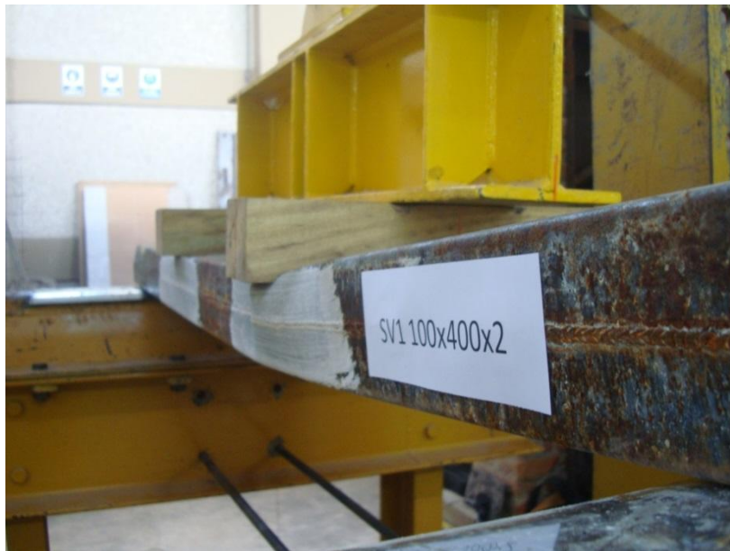
Fotografía 8 y 9: Falla del elemento sin Hormigón.
