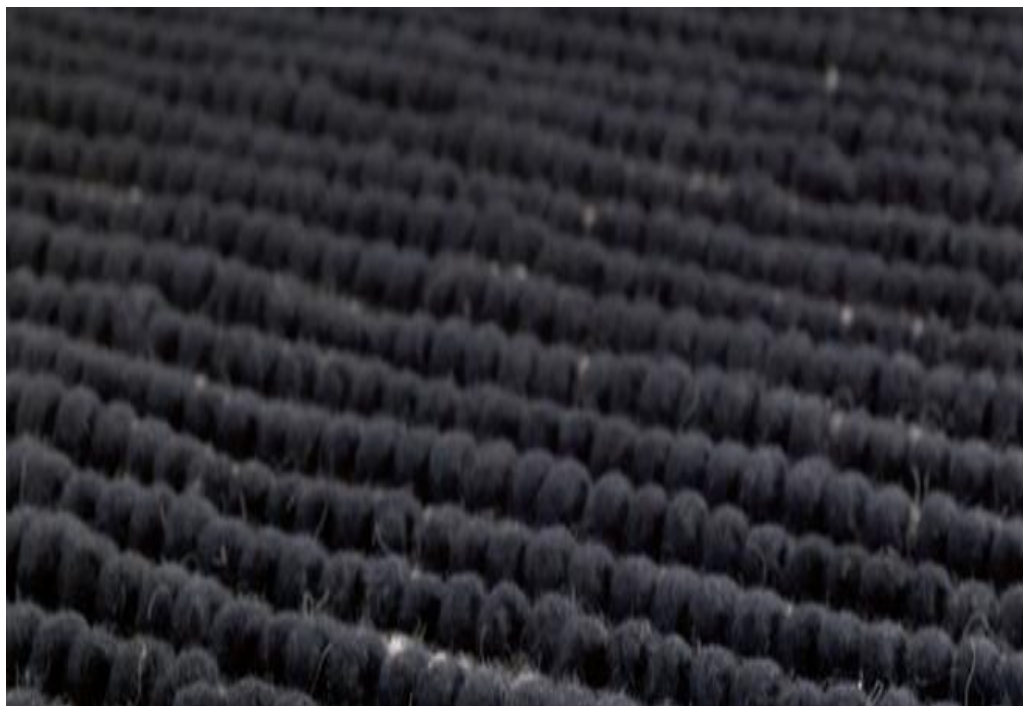
Figura 3.7. Alfombra de lana de 1,2 \text{ kg/m}^2 dispuesta para el piso
