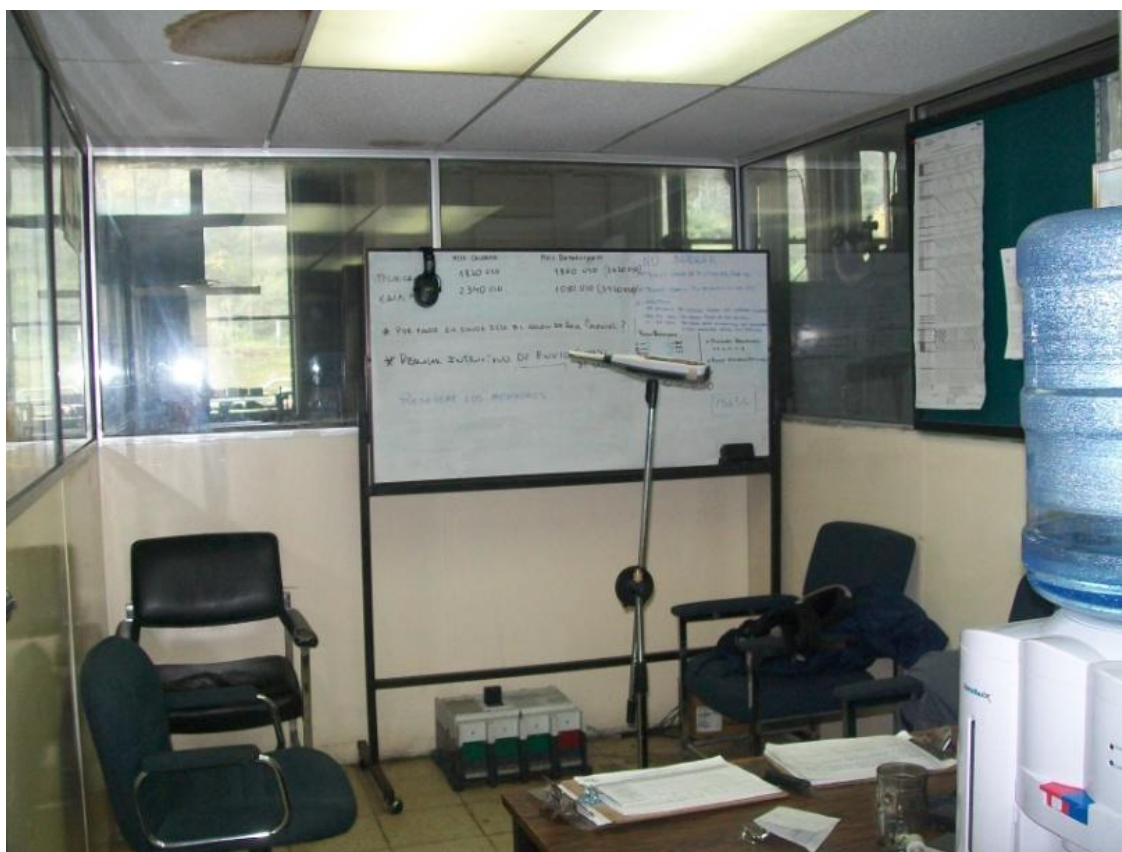
Figura 3.3. Medición de ruido del puesto de trabajo “Electricista”
