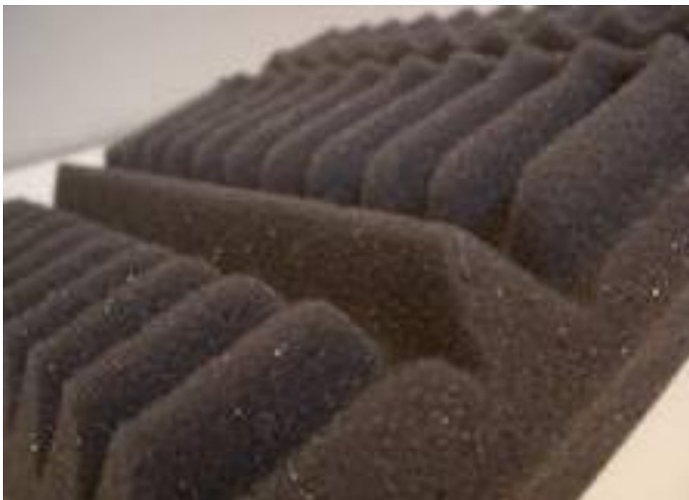
Figura 3.9. Sonex de 0,035 m dispuesto como material absorbente entre el techo y el cielorraso
