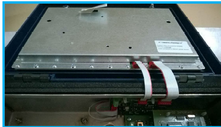
Figura 2. 32 Placa de detección de emisores
