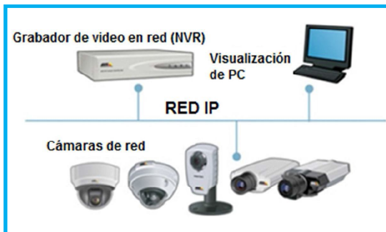
Figura 1.19 Grabador NVR con cámaras IP
