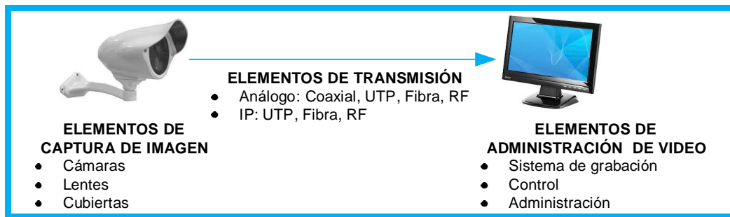
Figura 1.1 Sistema básico de CCTV
