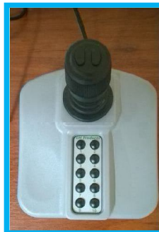
Figura 4. 16 Joystick asociado al monitoreo con la cámara PTZ de perímetro
