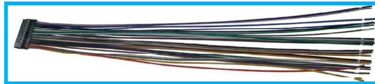
Figura 2. 29 Cable pulpo de biométrico con conector
