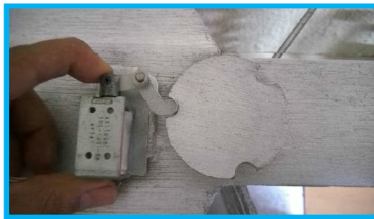
Figura 3. 64 Arreglo de placa de eje y solenoide
