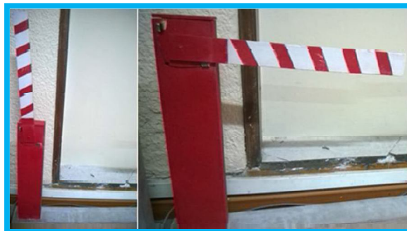
Figura 4. 35 Barrera vehicular abierta y cerrada luego de concedido el acceso
