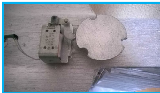
Figura 4. 29 Eje destrabado luego de que se ha concedido el acceso
