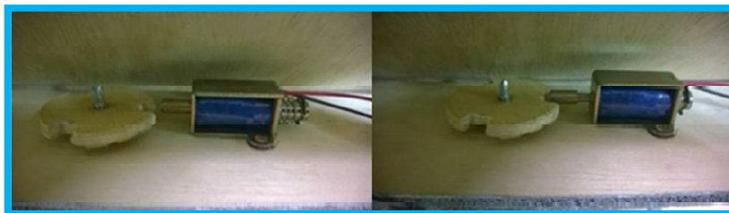
Figura 4. 33 Eje destrabado y trabado luego de concedido el acceso
