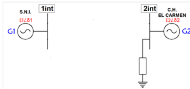
Fig. 3.29 Diagrama unifilar del SEP de la EPMAPS reducido para cada la condición de post-falla del escenario 3
