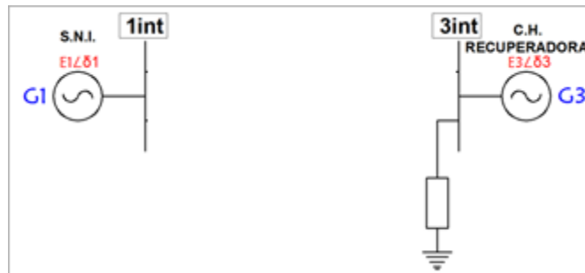
Fig. 3.23 Diagrama unifilar del SEP de la EPMAPS reducido para la condición de post-falla, del escenario 2
