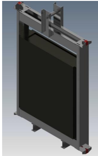
Figura 3.21 Contrapeso de hormigón.
