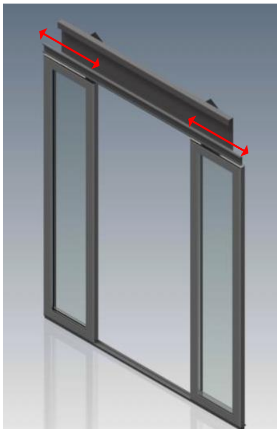
Figura 3.9 Puerta eléctrica deslizante.
