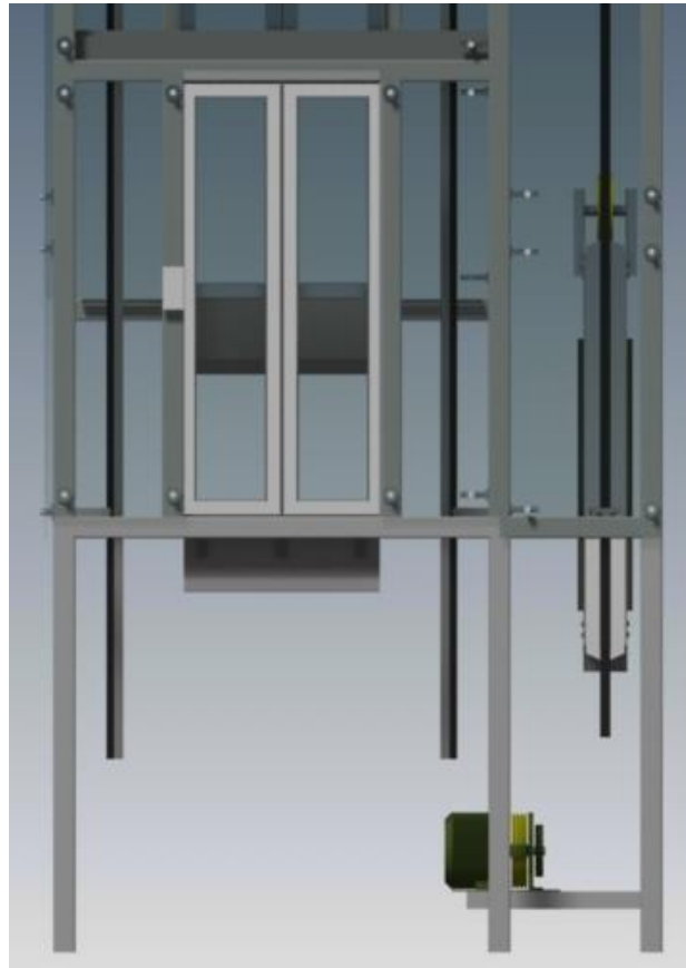
Figura 3.32 Vista de la planta baja y del emplazamiento del motor.
