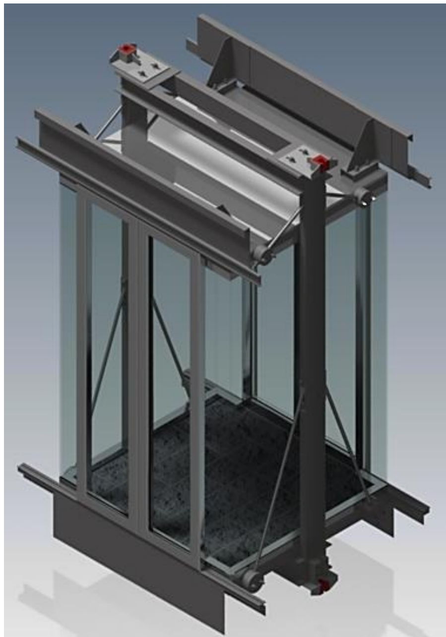
Figura 3.31 Vista isométrica de cabina.
