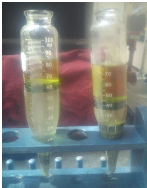
Figura 3.6. Fases formadas en la extracción de aceite después del proceso de centrifugación
