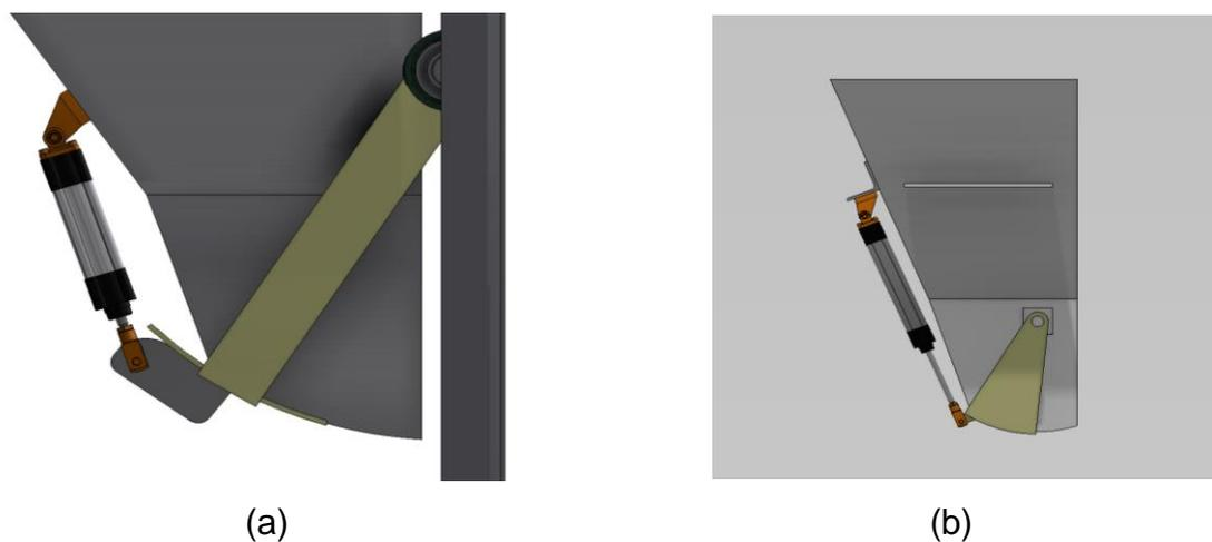
**Figura 3.9.** (a) Posición de apertura y (b) cierre de la compuerta
