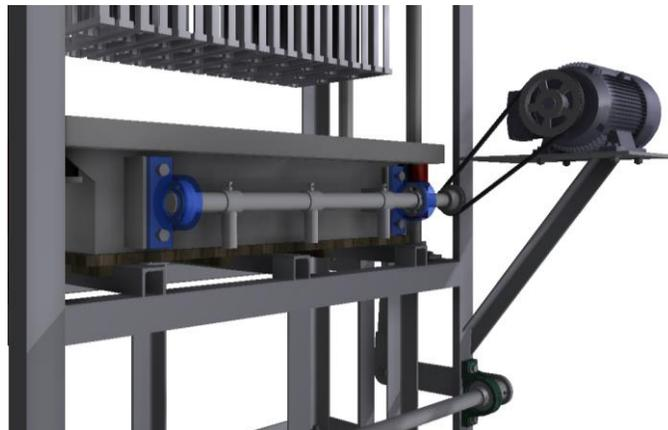
**Figura 3.43.** Esquema del sistema de vibraciones
