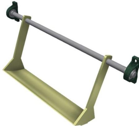
**Figura 3.12.** Compuerta de la tolva que pivota sobre el eje
