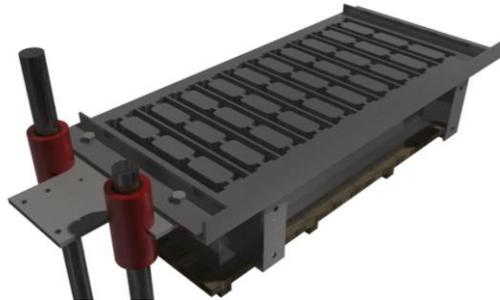
**Figura 4.3.** Placa empernada al molde y soldada a las correderas
