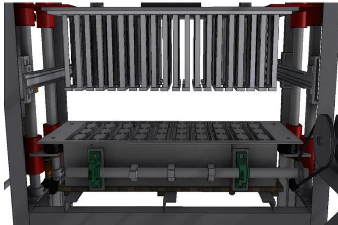
**Figura 3.47.** Posición inferior del molde
