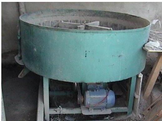
**Figura 1.8.** Mezcladora de eje vertical
