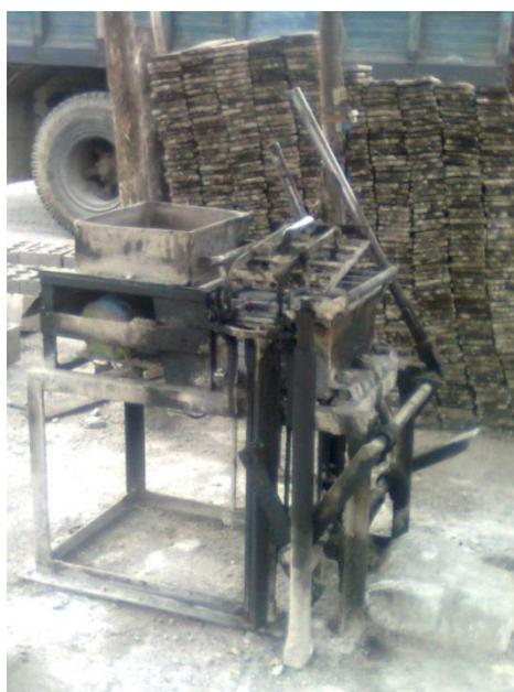
**Figura 1.1.** Máquina manual para la fabricación de bloques
