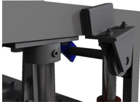
**Figura 4.8.** Montaje de la polea a la estructura
