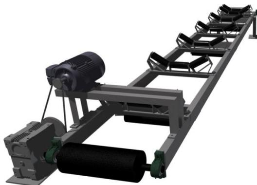
**Figura 1.16.** Banda transportadora
