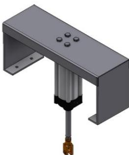
**Figura 3.29.** Montaje de cilindro al perfil C
