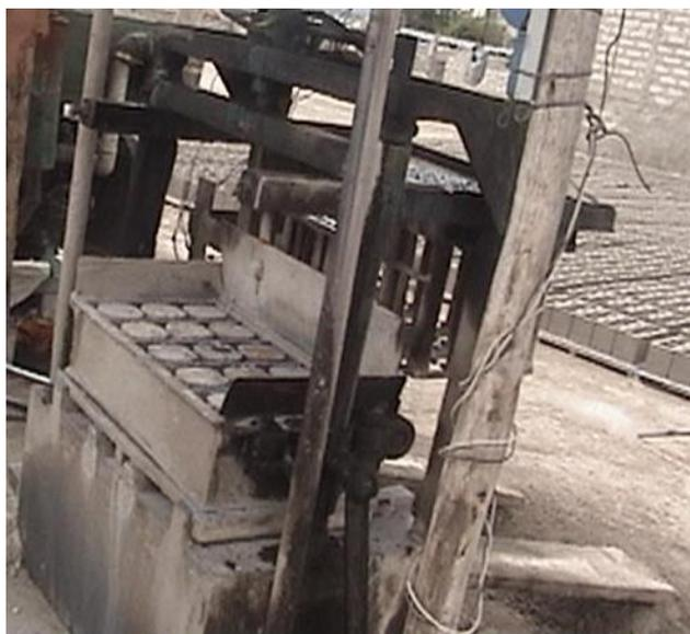
**Figura 1.2.** Máquina prensadora utilizada en la fábrica
