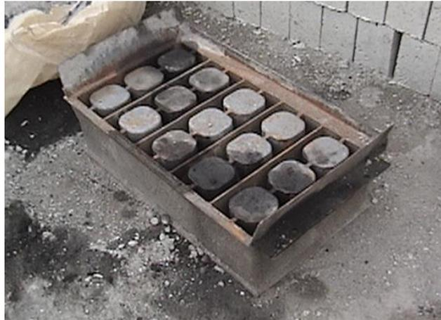
**Figura 2.6** Molde para fabricar bloques
