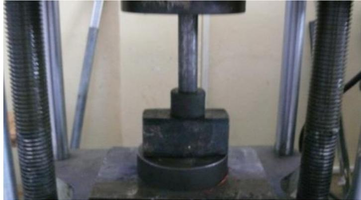
**Figura 3.38.** Montaje del amortiguador a la máquina universal de ensayos
