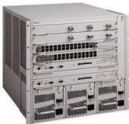
Figura 3.21 Equipo Metro Ethernet Routing Switch 8600 de Nortel
