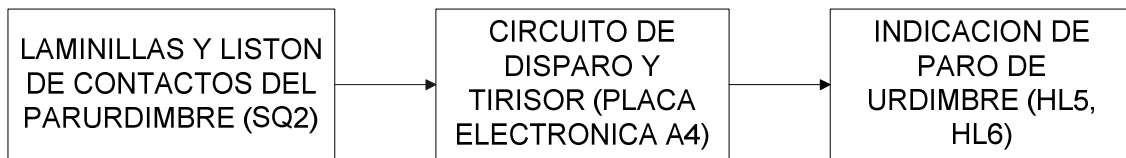
Figura 2.4 Señal para indicación de paro de urdimbre
