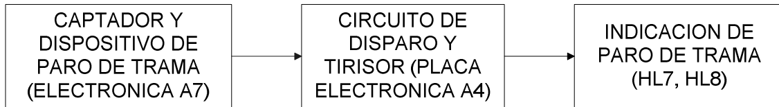
Figura 2.5 Señal para indicación de paro de trama
