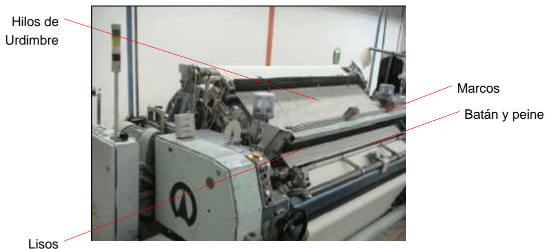
Figura 1.5 Partes del telar que son utilizadas para iniciar la fabricación del tejido
