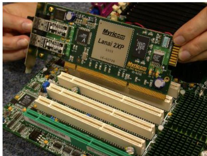
Figura 4. 14 Instalación en Host con unidad de puertos PCI tipo montaje en rack. [42]
