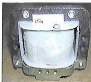
Fig. 2.10: Transformador de voltaje
