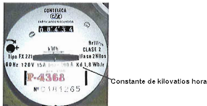
Fig. 3.2: Dato de placa de un medidor indicando la constante de kilovatios hora
