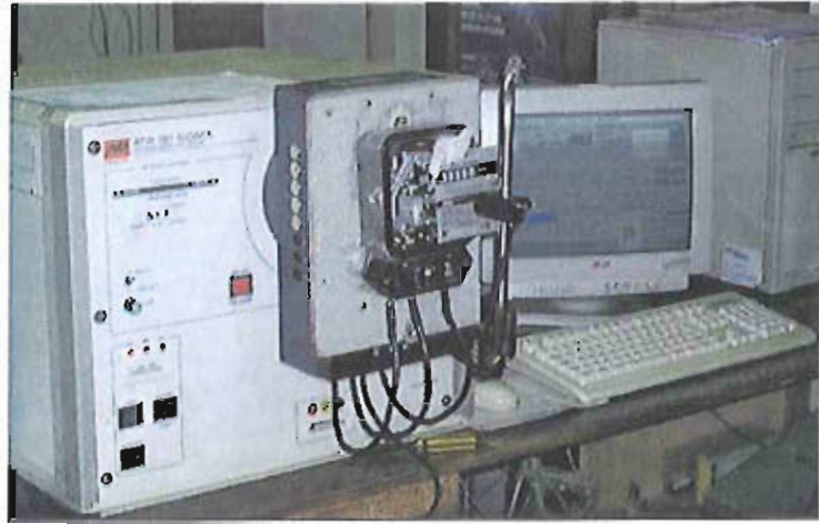
Fig. 3.6: Contrastador electrónico marca AVO en proceso de contrastación.
