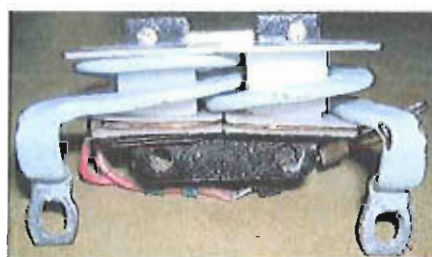
Fig. 2.11: Transformador de corriente
