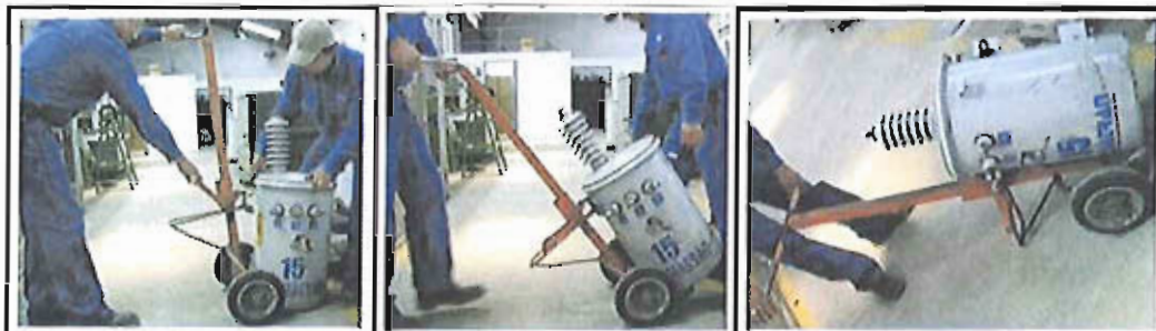
Fig. 4.23: Equipo manual empleado por la EEQ para transportar transformadores.
